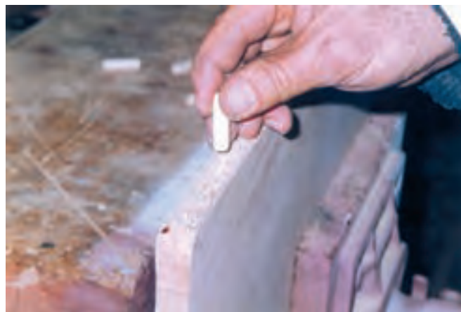
شکل ۲۵ - جازدن دوبل‌ها در نر صفحات
