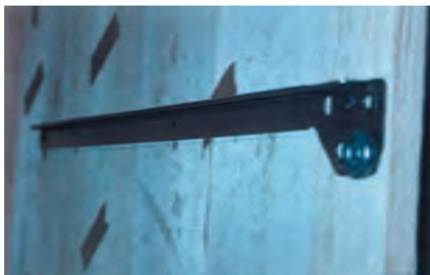
شکل ۳۱- نصب ریل روی بدنه
