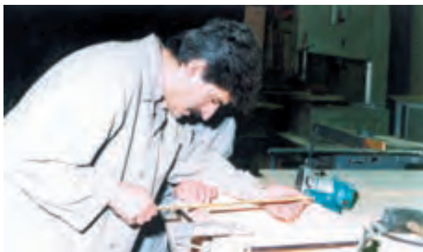
شکل ۲۹- سرهم کردن جعبه و گونیايي کردن آن
