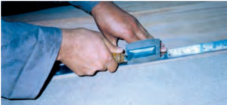
شکل ۱۷- قطع روکش به وسیله‌ی اره‌ی روکش‌بری
