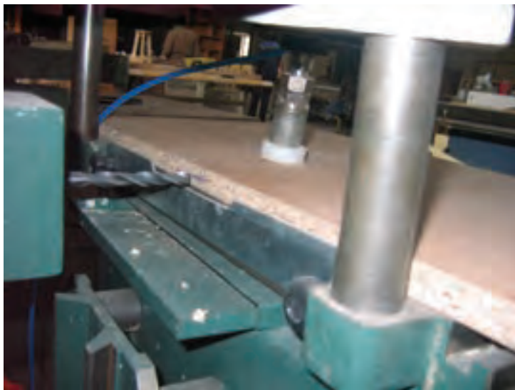
شکل ۱۹- سوراخ نمودن نر نتوپان با ماشین کم کن مته‌ای
