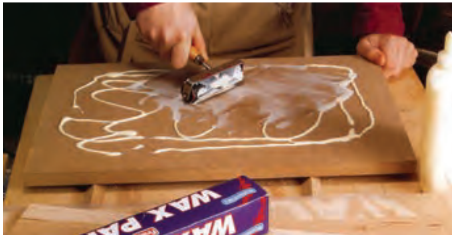
شکل ۷- عملیات چسب‌زنی نئوپان برای روکش‌کاری
