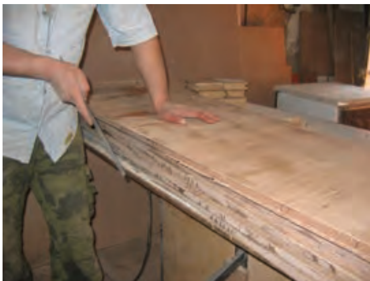
شکل ۲۲- برطرف کردن لبه های اضافی روکش
