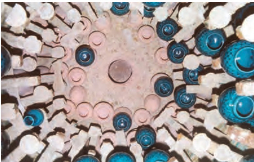
تصویر ۱۸- فضای داخلی کوره سنتی برای پخت بدنه‌های خام و لعابدار
