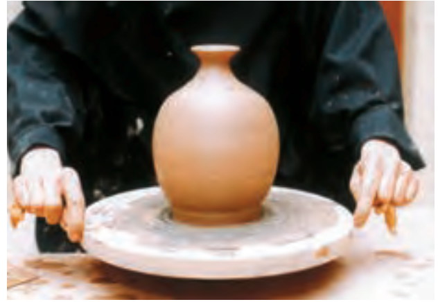
تصویر ۵۲ - جدا کردن کوزه از سرچرخ به وسیله مفتول سیمی
