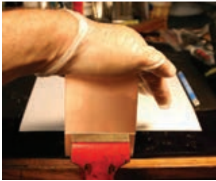
شکل ۳-۵- شکستن فیبر خام به وسیله گیره فلزی
