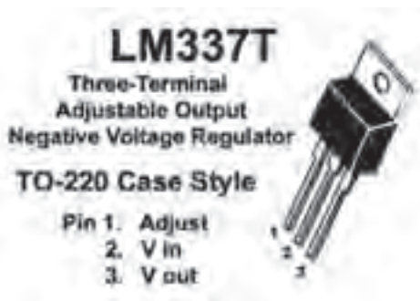
شکل ۱۶-۲- شکل ترانسفورماتور کاهنده 220^\circ به ۱۸ ولت دوپل شکل ۱۷-۲- ترتیب پایه‌های آی‌سی رگولاتور LM337
