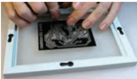
شکل ۱۹-۳- چسباندن نگاتیو روی شیشه
