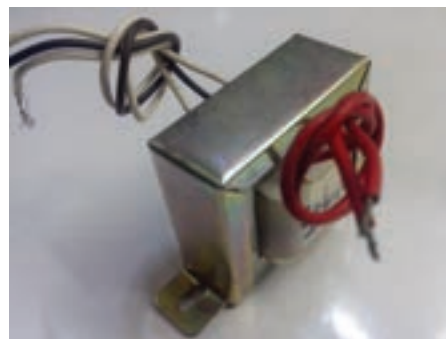
شکل ۱۶-۲- شکل ترانسفورماتور کاهنده 220^\circ به ۱۸ ولت دوپل شکل ۱۷-۲- ترتیب پایه‌های آی‌سی رگولاتور LM337
