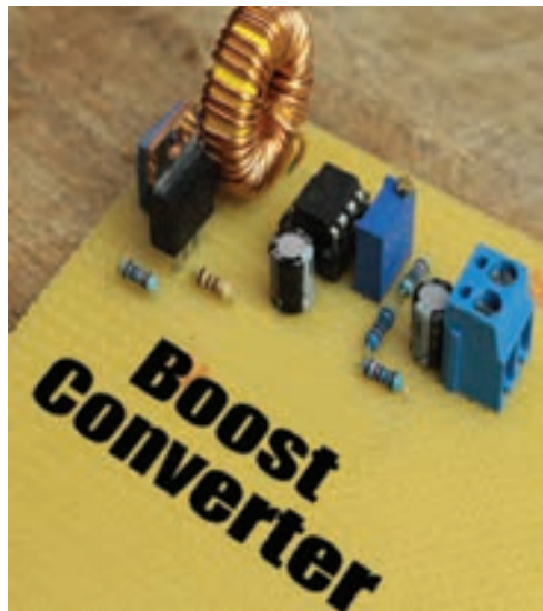
شکل ۳۱-۲- یک نمونه مدار مبدل DC به DC
