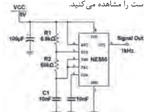
شکل ۲-۲۷- مدار مولد موج مربعی با آی سی ۵۵۵
