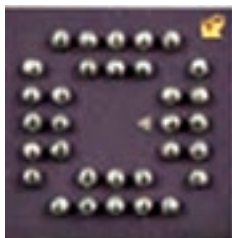
شکل ۱۱۱ - تصویر ظاهری انواع پکیج‌های BGA
