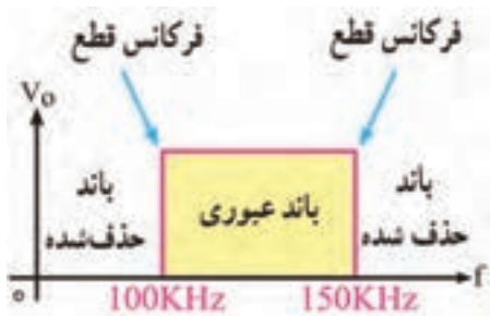
شکل ۵-۶ منحنی پاسخ فرکانسی فیلتر ایده‌آل
