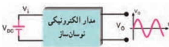
شکل ۶-۲۳ نقشه بلوکی نوسان‌ساز سینوسی
