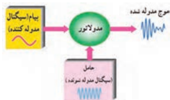
شکل ۶-۴۸ بلوک دیاگرام نحوه انجام مدولاسیون
