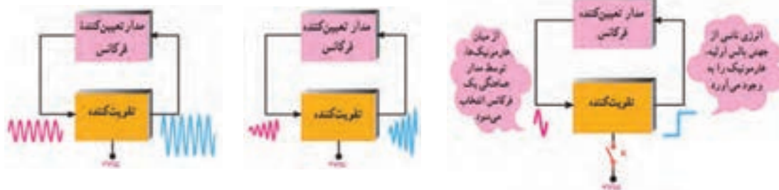
الف) با فعال کردن کلید دستگاه روشن می‌شود ب) سیگنال اولیه ساخته می‌شود پ) نوسان‌ها پایدار می‌شود
