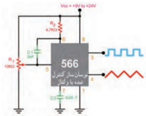
شکل ۵۷-۶ نوسان‌ساز با فرکانس قابل کنترل با ولتاژ
