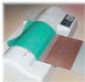
شکل ۳-۱۵- ورود فیبر به لمینتور
