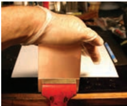
شکل ۳-۵- شکستن فیبر خام به وسیله گیره فلزی
