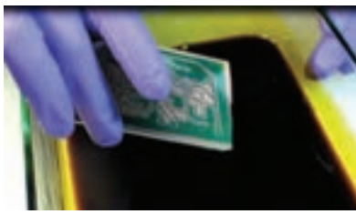
شکل ۳-۲۶- فیبر ظاهر شده پس از شست‌وشو شکل ۳-۲۷- قرار دادن فیبر داخل اسید شکل ۳-۲۸- خروج فیبر از اسید
