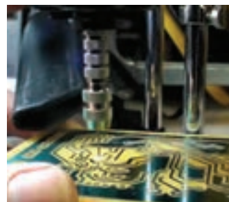
شکل ۳-۲۹- سوراخ کاری فیبر مدار چاپی شکل ۳-۳۰- پاک کردن لامینت اضافی شکل ۳-۳۱- فیبر آماده شده نهایی
