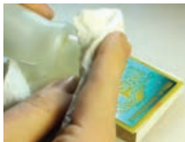
شکل ۳-۲۹- سوراخ کاری فیبر مدار چاپی شکل ۳-۳۰- پاک کردن لامینت اضافی شکل ۳-۳۱- فیبر آماده شده نهایی
