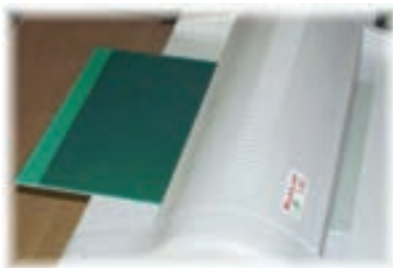
شکل ۳-۱۶- خروج فیبر از لمینتور
