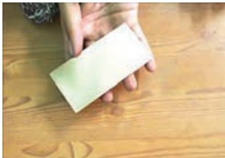
شکل ۳-۱۰- فیبر مسی تمیز شده
