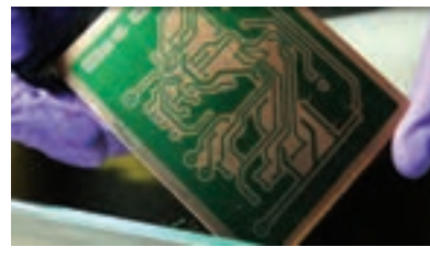
شکل ۳-۲۶- فیبر ظاهر شده پس از شست‌وشو شکل ۳-۲۷- قرار دادن فیبر داخل اسید شکل ۳-۲۸- خروج فیبر از اسید
