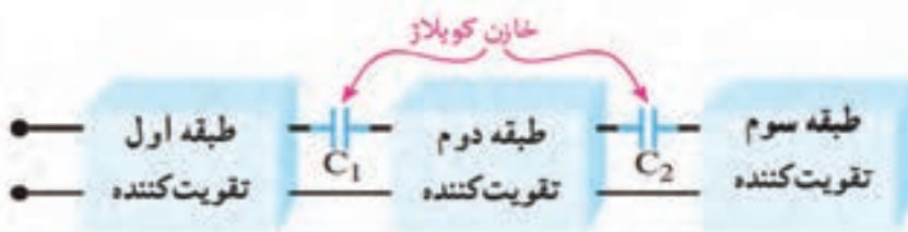
شکل ۴-۴ بلوک دیاگرام سه طبقه تقویت‌کننده با کوپلاژ خازنی
