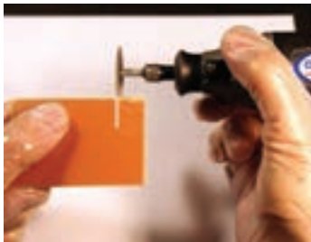
شکل ۸-۳- بریدن فیبر با مینی‌فرز
