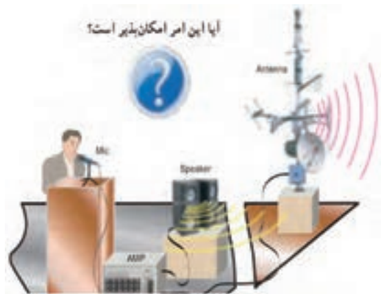
شکل ۶-۴۷ تبدیل امواج صوتی به امواج الکترومغناطیس
