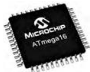
شکل ۱۰۹ - تصویر ظاهری انواع پکیج‌های QFP
