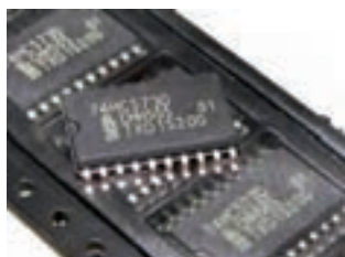
شکل ۱۰۸ - تصویر ظاهری انواع پکیج‌ها SOIC
