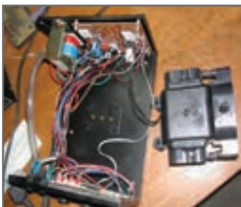
شکل ۹۲- جداسازی مولد هوای فشرده (کمپرسور)
