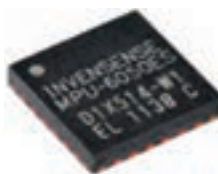
شکل ۱۱۰ - تصویر ظاهری انواع پکیج‌های TDFN, DFN
