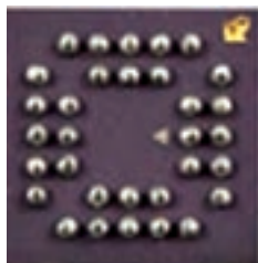
شکل ۱۱۱ - تصویر ظاهری انواع پکیج‌های BGA
