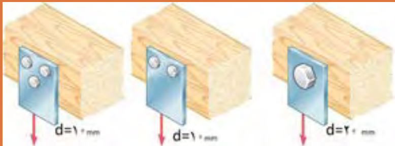
چند روش اتصال تسمه به دیوار چوبی تحت بارگذاری برشی
