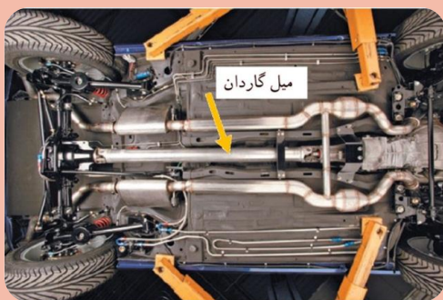
میل گاردان بارگذاری پیچشی را برای انتقال گشتاور تحمل می‌کند.
