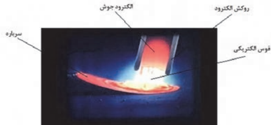
شکل ۱ - جوش کاری با الکتروود روپوش دار
