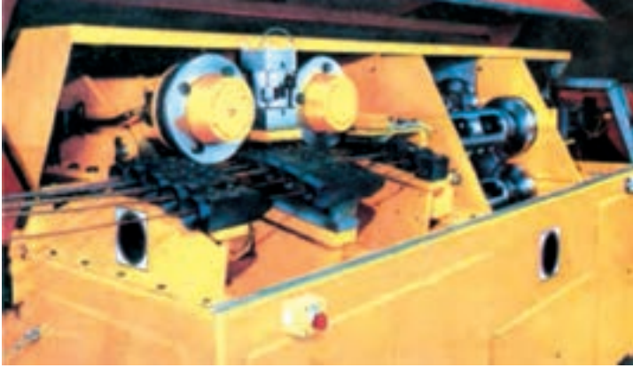
دستگاه کشش برقی برای صاف کردن میلگرد
