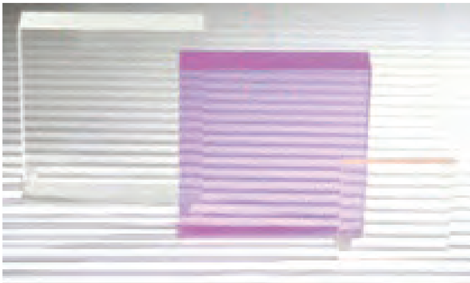
شکل ۱۴- نمونه‌هایی از سرامیک‌های شفاف (YAG)
