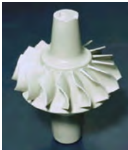
شکل ۲۸- پره توربین \text{Si}_3\text{N}_4
