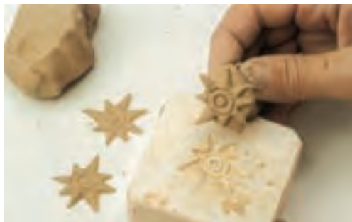
شکل ۱۴- فشار دادن مقداری گل درون قالب
