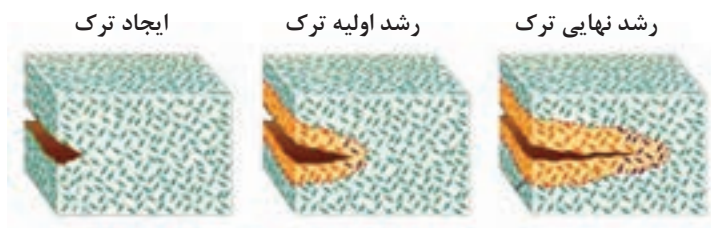
شکل ۲۳- گسترش ترک و مقاومت ماده در برابر آن (چقرمگی)
