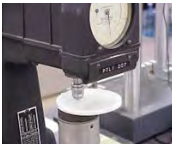
شکل ۲۰- روش‌های دستی و دستگاهی تعیین سختی
