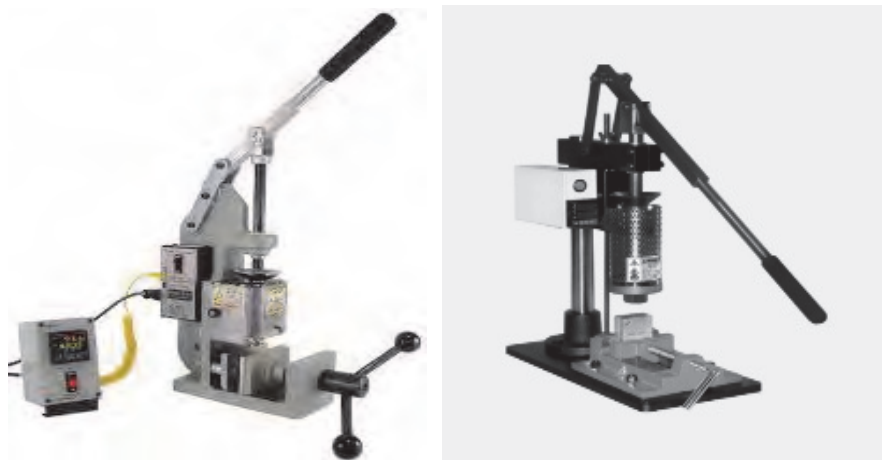
شکل ۲۱- دستگاه نیمه اتوماتیک (دستی) قالبگیری تزریقی
