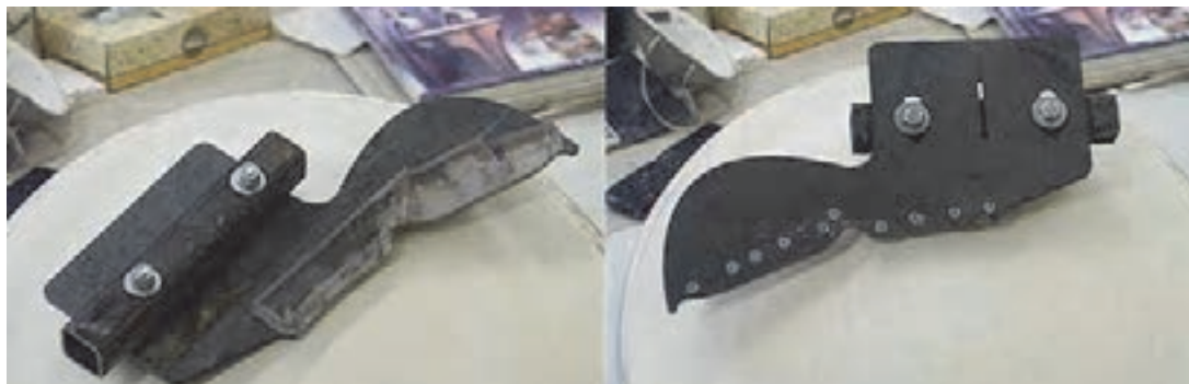
شکل ۲۰- شابلون با پیچ و مهره قابل تنظیم
