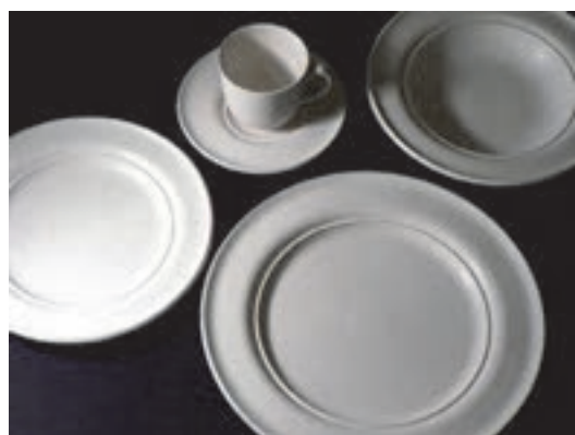
شکل ۵- قطعات تولیدشده به روش جیگر و جولی
