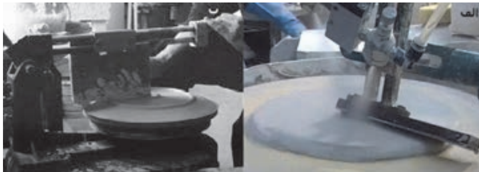
شکل ۳۲- الف) پهن کردن گل، ب) شکل دادن
