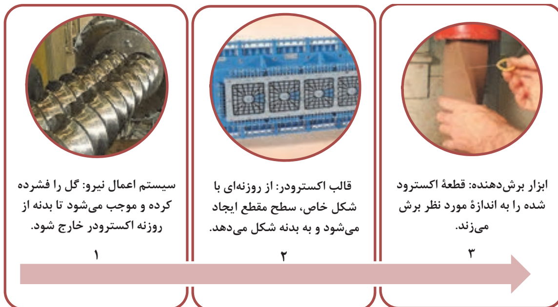
شکل ۶- اجزاء ماشین اکسترودر
