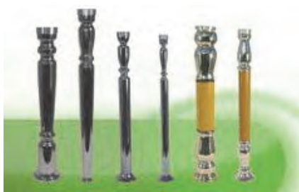
شکل ۳- قطعات فلزی شکل داده شده با تراش
