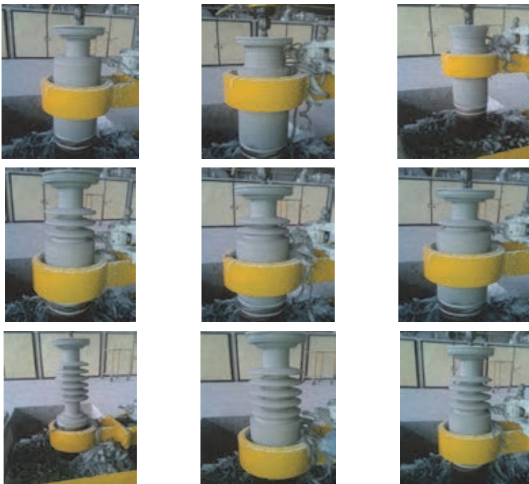
شکل ۲۳- مراحل تراش مقره پوشینگ
