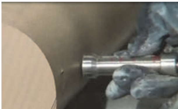
شکل ۱۰- اندازه‌گیری سختی شمش گل قبل از شکل‌دهی
