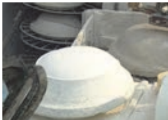
شکل ۳۱- قرار دادن قالب بر روی زبانه
