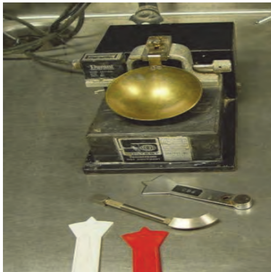
شکل ۱۴- جام کاساگرانده و شیارزن
