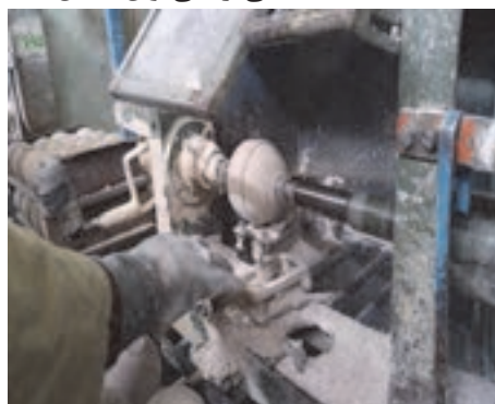
شکل ۵- شکل‌دهی قطعات سرامیکی به روش تراش
