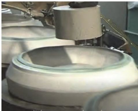
شکل ۳۸- قرار دادن دیسک گل در قالب
