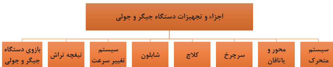
شکل ۱۴- اجزا و تجهیزات دستگاه جیگر و جولی
