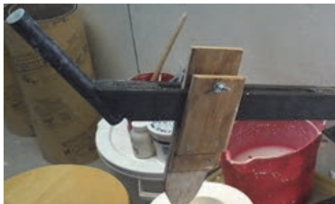
شکل ۱۹- شابلون چوبی و پلاستیکی تقویت‌شده با چوب
