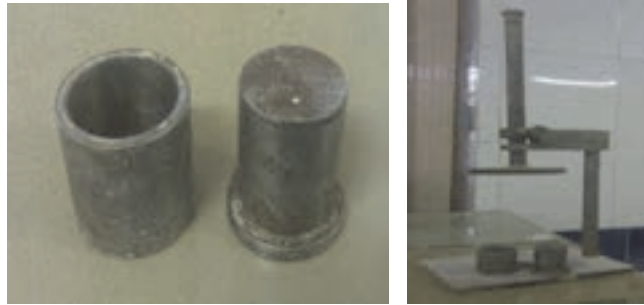
شکل ۱۷- دستگاه ففرکورن و قالب نمونه‌ساز
