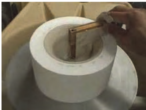
شکل ۳۹- پایین آوردن بازوی جولی و شکل‌دهی
