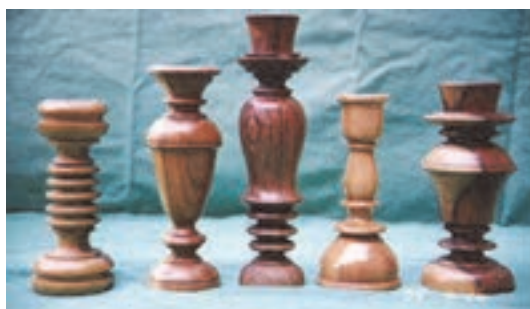
شکل ۲- قطعات چوبی شکل داده شده با تراش
