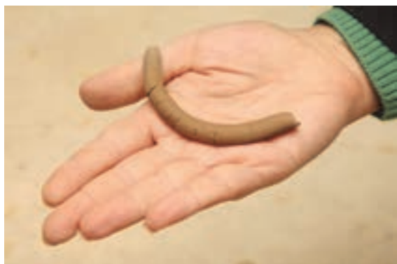
شکل ۱۵- بررسی فتیله در روش آتربرگ
