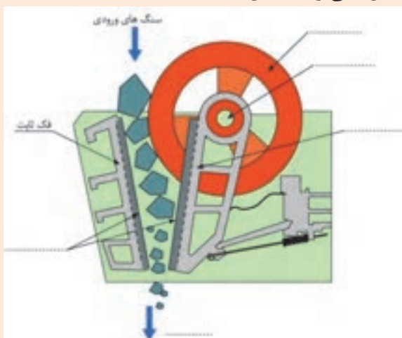
شکل ۱۹- اجزای سنگ شکن فکی
