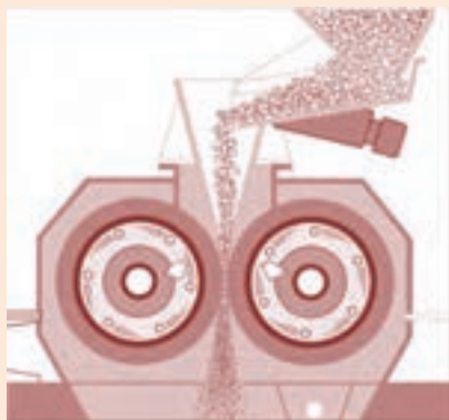
شکل ۳۰- جهت چرخش استوانه‌ها در سنگ شکن غلتکی
