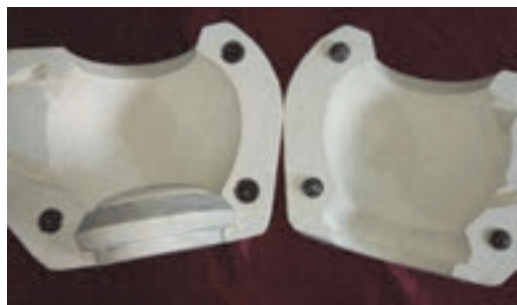
شکل ۲۴- الگوی گچی با زبانه های پلاستیکی
