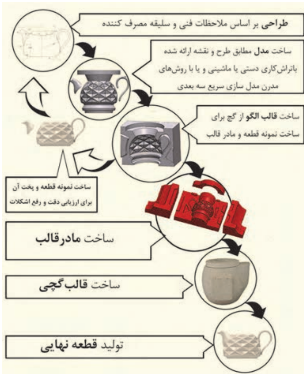
شکل ۶- مراحل ساخت قطعه سرامیکی
