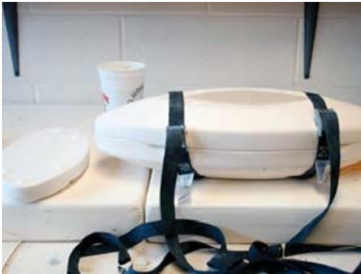
شکل ۱۵- روش‌های مختلف بستن قالب
