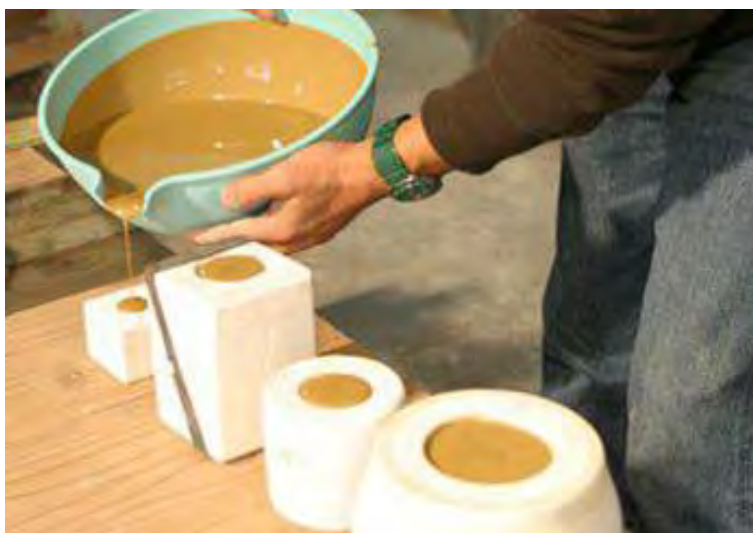
شکل ۴۷- پر کردن قالب با سرعت مناسب
