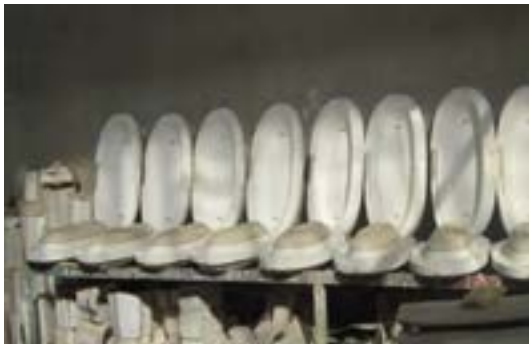
شکل ۲۸- باز کردن قالب
