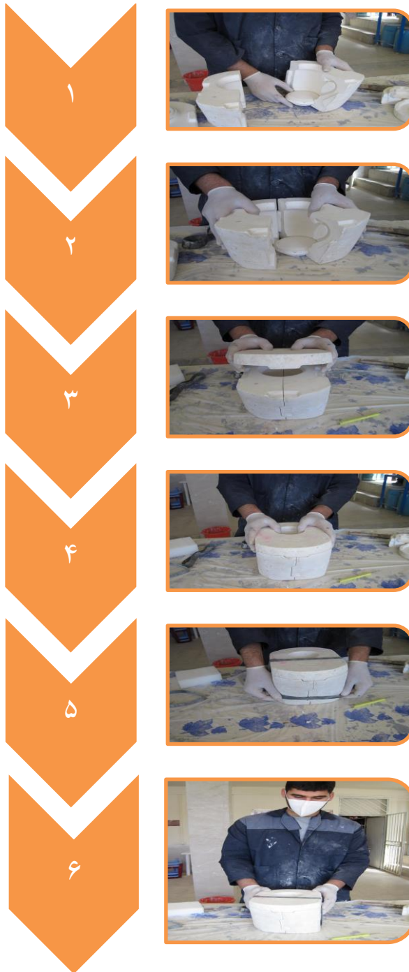
شکل ۷- مراحل بستن قالب
