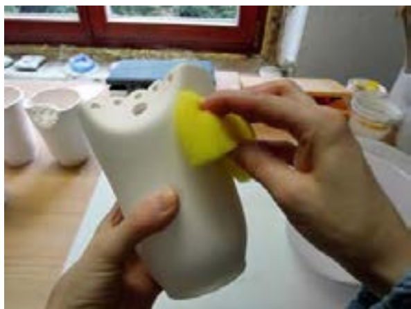
شکل ۳۱- پرداخت بدنه‌های ریخته‌گری دوغابی
