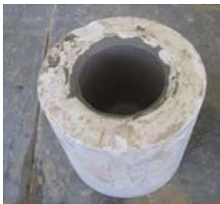
شکل ۹- قالب نمونه برای تعیین سرعت ریخته‌گری
