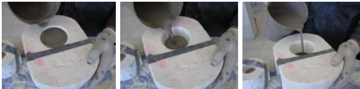
شکل ۲۰- ریختن دوغاب در قالب
