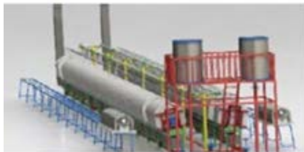
ب) قرار دادن مخزن دوغاب در ارتفاع
