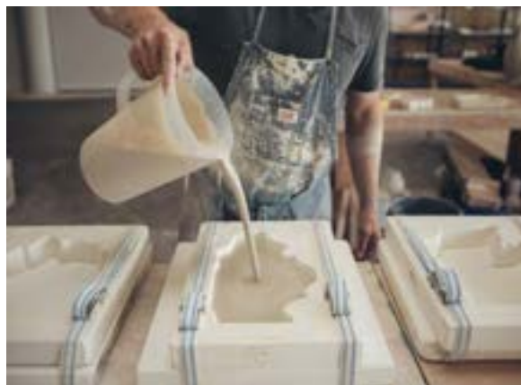
الف) ریخته‌گری دوغابی به روش دستی
