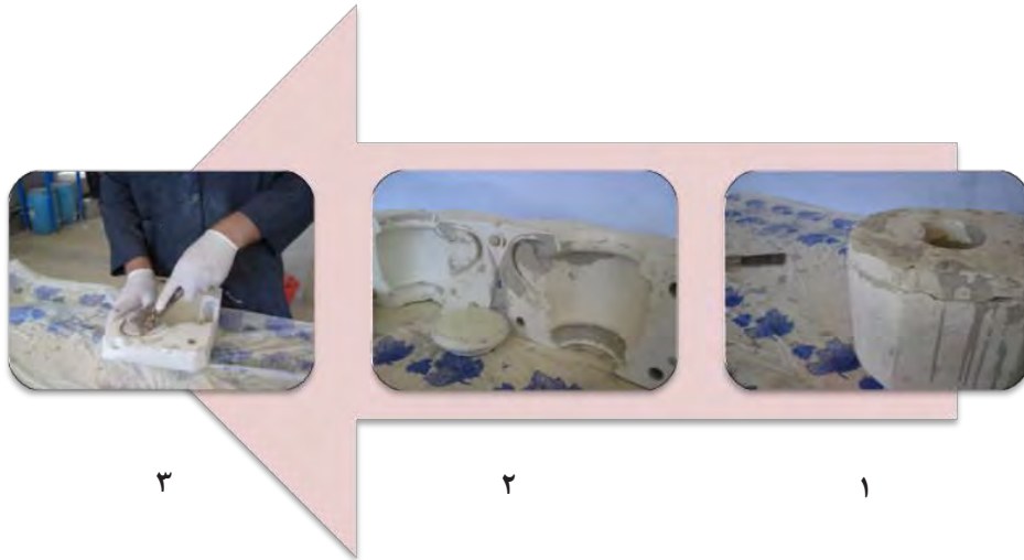
شکل ۵- بررسی قالب و جدا کردن لایه‌های دوغاب خشک شده از آن
