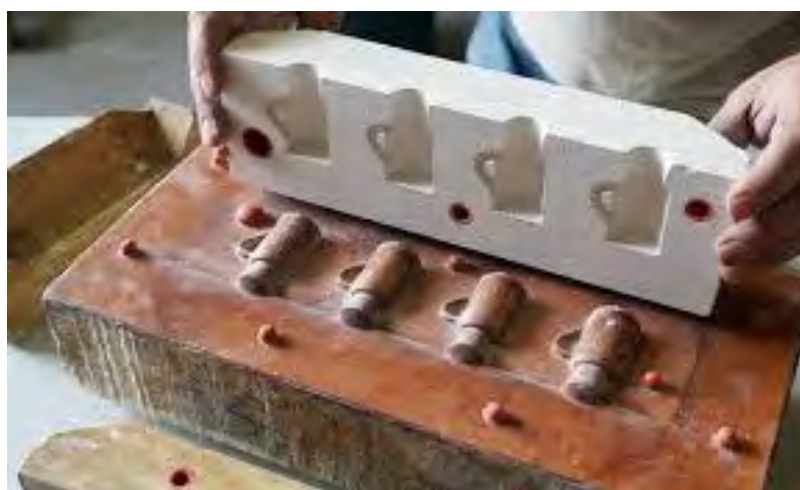
شکل ۴- قالب گچی با قابلیت ریخته‌گری چهار قطعه
