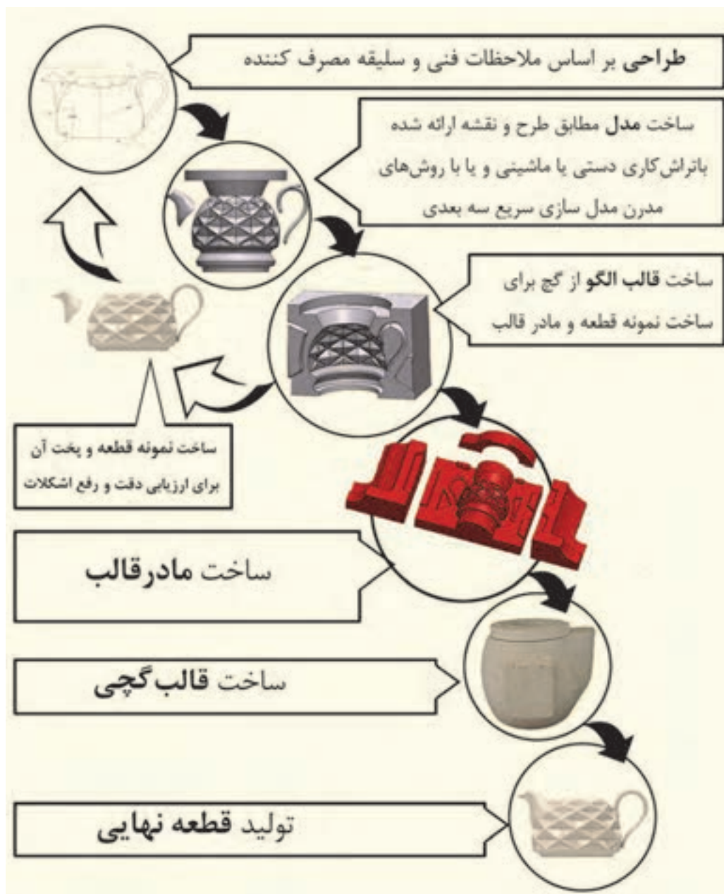
شکل ۶- مراحل ساخت قطعه سرامیکی
