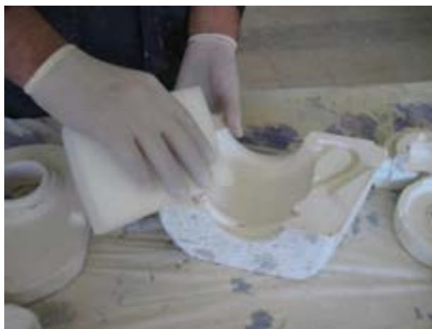
شکل ۴- زدودن گرد و غبار از قالب
