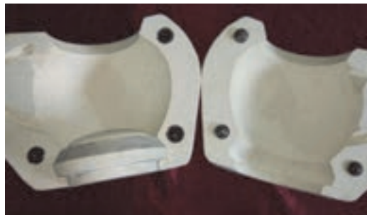
شکل ۲۴- الگوی گچی با زبانه‌های پلاستیکی
