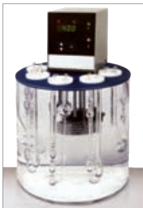
شکل ۱۱-۳- حمام مجهز به کنترل کننده دما
