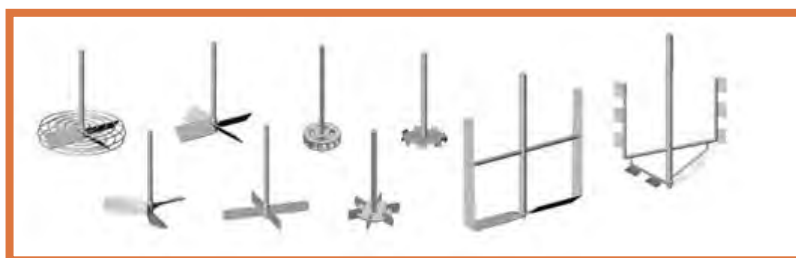
شکل ۶-۴ انواع هم‌زن‌های مورد استفاده در رآکتور
