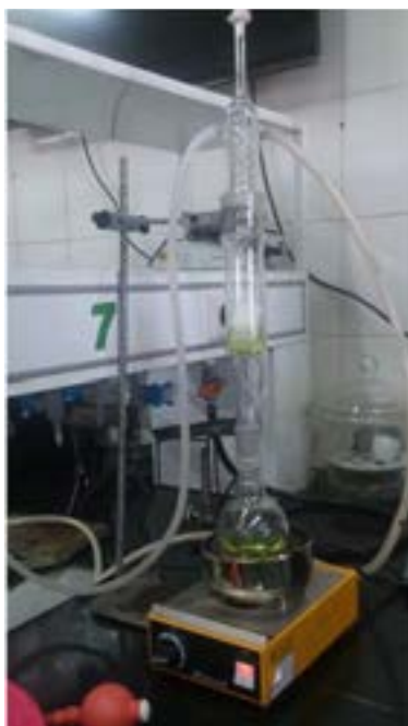
شکل ۱۸-۵ شمای ساده‌ای از سوکسله
