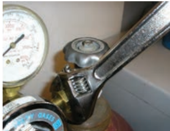
نحوه بستن رگولاتور به کپسول
