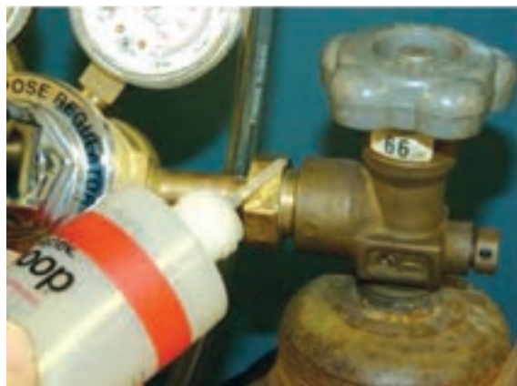
تست نشتی بعد از بستن رگولاتور
