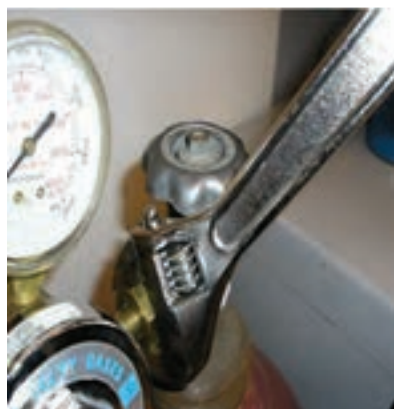
بازکردن رگولاتور از کپسول
