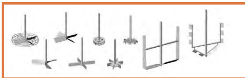
شکل ۶-۴ انواع هم‌زن‌های مورد استفاده در رآکتور
