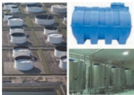
شکل ۱۴-۴ مخازن استوانه‌ای کم فشار
