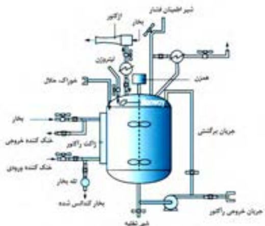
شکل ۴-۱۲ رآکتور مخزنی همزن دار مداوم
