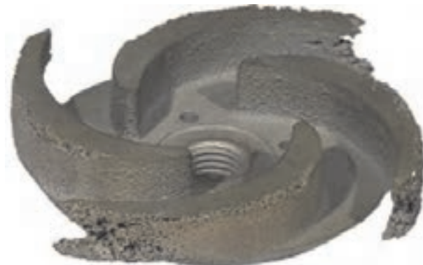
شکل ۱۸-۳ آسیب‌دیدگی پروانه پمپ در اثر پدیده کاویتاسیون
