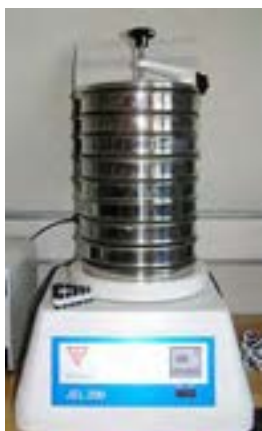
شکل ۲-۵ مجموعه الک‌ها بر روی دستگاه لرزاننده
