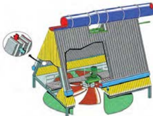
شکل ۲-۱۴ برج خنک کننده خشک با جریان هوای القایی
