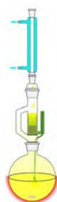
شکل ۱۸-۵ شمای ساده‌ای از سوکسله
