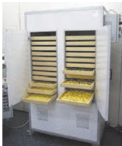
شکل ۱۸-۲ دستگاه خشک‌کن کابینتی
