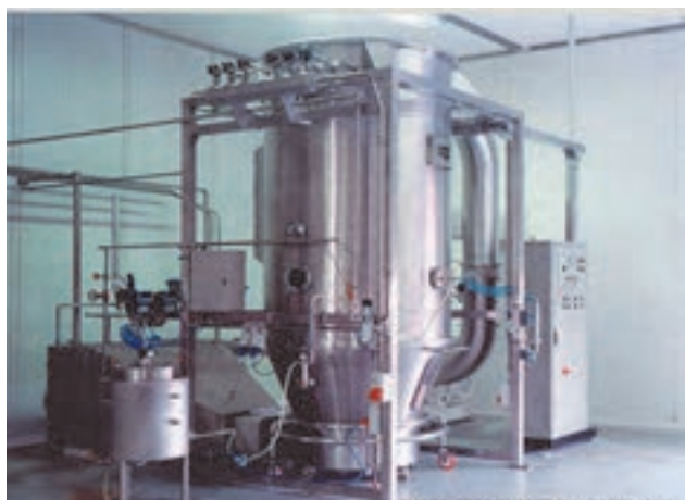
شکل ۲۴-۳-مخلوط‌کن بستر سیال
