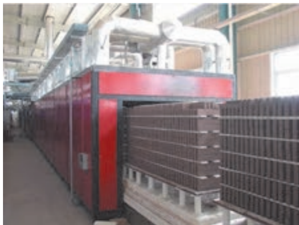
شکل ۱۹-۲ دستگاه خشک‌کن تونلی واگن‌دار
