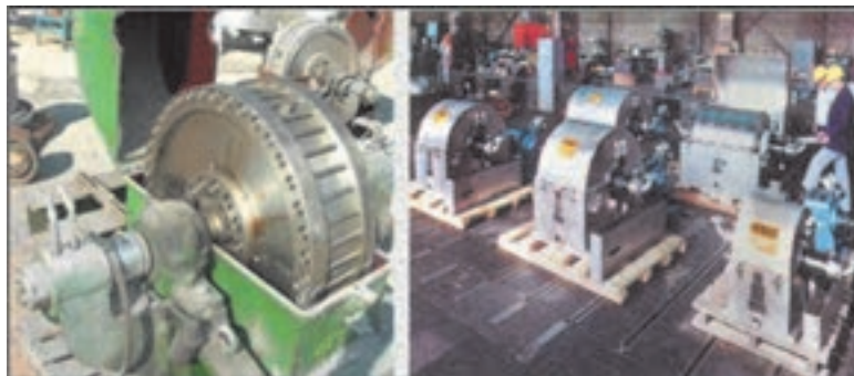
شکل ۱۷-۵ دستگاه‌های استخراج مایع - مایع گریز از مرکز
