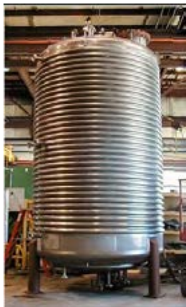
شکل ۵-۴ رآکتور ناپیوسته با سیستم حرارتی کویل
