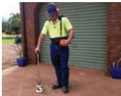
شکل ۲۴- تشخیص نشتی آب با دستگاه نشت یاب فراصوت ۱
