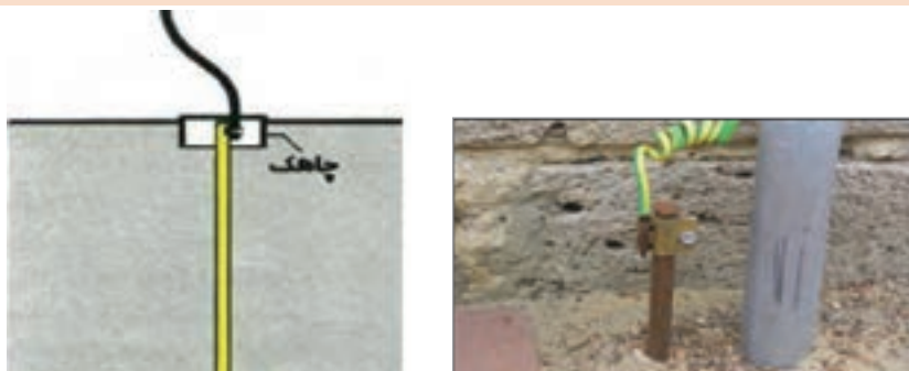
شکل ۴ - نحوه اتصال به چاه ارت
