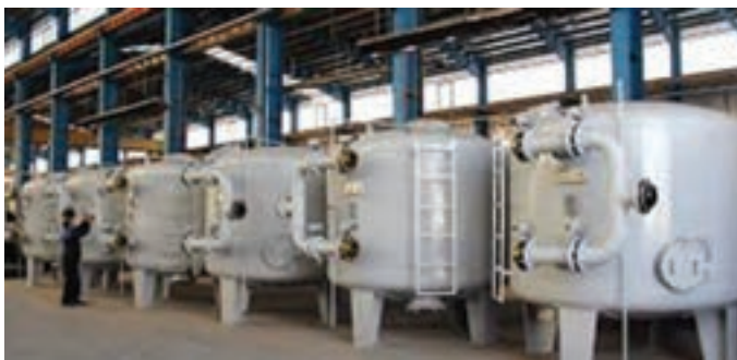
شکل ۵- نمای درونی و بیرونی صافی صنعتی
