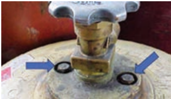
شکل ۳۲- مجرای ذوب شدنی روی شانه یک سیلندر گاز تحت فشار و یک مجرای ذوب شدنی مجزا قبل از نصب
