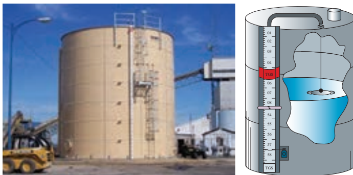
شکل ۳- اندازه گیری سطح سیال با استفاده از سطح سنج در تانک ذخیره
