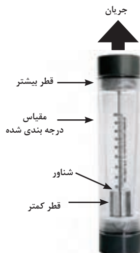
شکل ۷ - یک نمونه روتامتر معمولی
