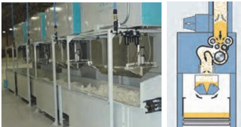
شکل ۱-۵ دستگاه تغذیه وزنی و عملکرد درون آن
