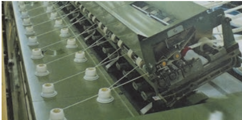
شکل ۴-۳۳ خروج نیمچه نخ از منطقه کشش
