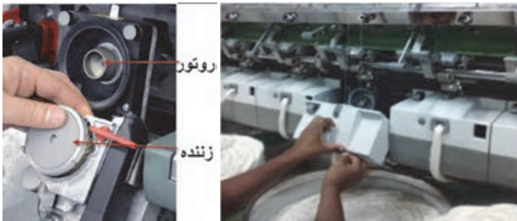
شکل ۶-۴ پیوند نخ در داخل روتور
