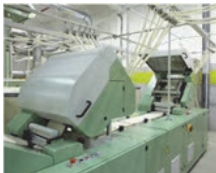
شکل ۳-۲۲ نمای عمل تغذیه و کشش در ماشین بالشچه
