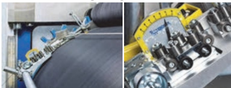
۲-۲۵ نحوه پیچش نوار خاردار متالیک و ابزار تعیین میزان کشیدگی نوار متالیک
