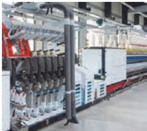
شکل ۳۳-۵ تمیز کننده سیار با دمنده ها و مکنده های روی آن
