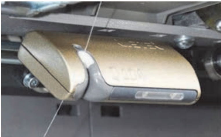
شکل ۱۴-۴ کنترل کننده و تمیز کننده نخ
