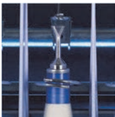
شکل ۲۰-۵ راهنما و حلقه کنترل بالون و صفحه جدا کننده و ماسوره نخ
