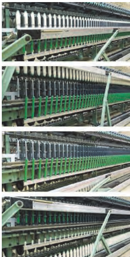
شکل ۳۲-۵ مراحل داف اتوماتیک در ماشین رینگ و مراحل آن
