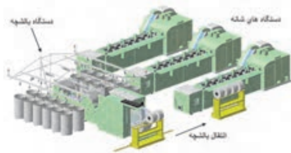
شکل ۲۵-۳ انتقال قفسه بالشچه به قسمت تغذیه شانه
