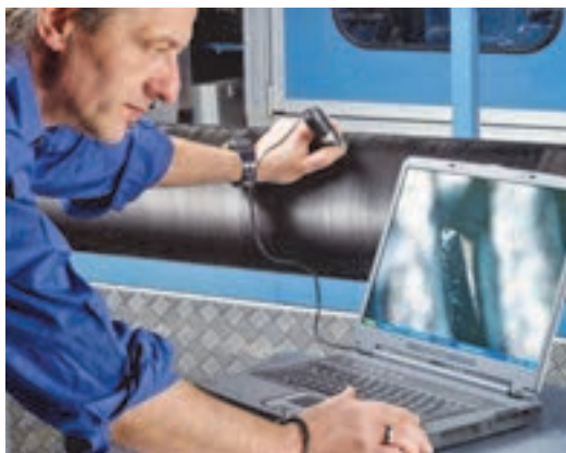
۲۲-۲ ابزارهای مشاهده عیوب نوار اریه‌ای (وایر) کاردینگ
