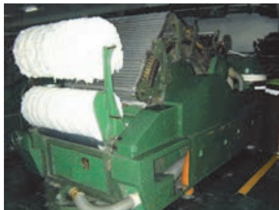
شکل ۴-۲ تغذیه کاردینگ با بالش
