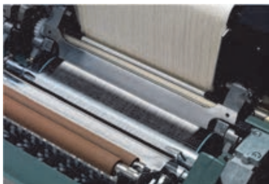
شکل ۳۰-۳ یک واحد چشمه از یک ماشین شانه زنی و اجزاء آن
