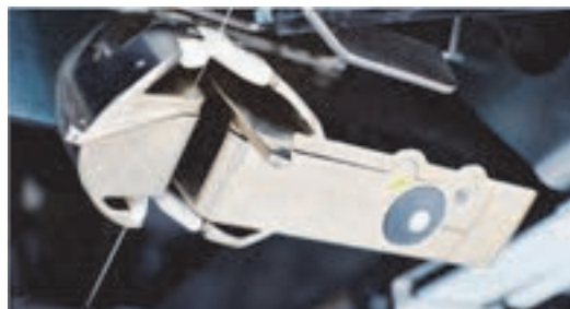
شکل ۴۰-۵ کنترل کننده تمیز کننده و قطع کننده نخ
