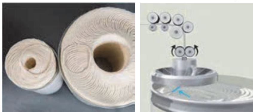
شکل ب ۱۱-۳، کویلر و نحوه قرار گرفتن فتیله در بانکه
