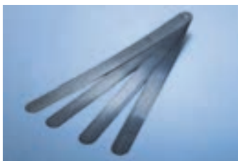
شکل ۱۸-۲ دسته فیلر برای گیج گذاری کاردینگ
