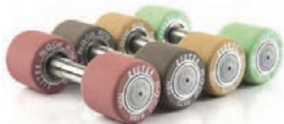
شکل ۹-۵ غلتک با روکش لاستیکی فوقانی سیستم کشش
