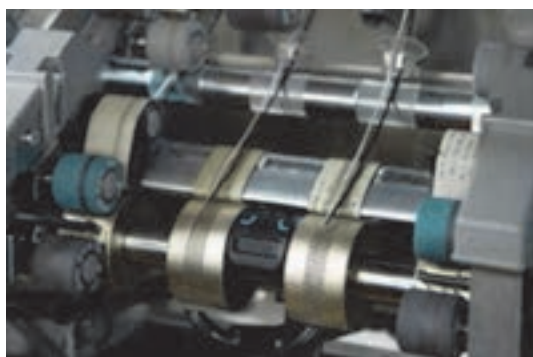
شکل ۱۴-۵ یک واحد غلتک مشبک کشش رینگ (کامپکت)
