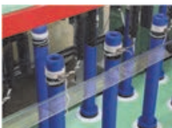
شکل ۳۵- بوبین پلاستیکی نصب شده روی دوک
