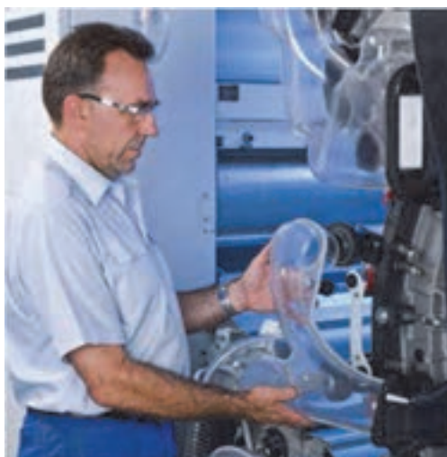
شکل ۲-۵۳ سهولت نصب و خارج کردن کانال‌های هوا و درب‌های آن در کاردینگ‌های جدید.
