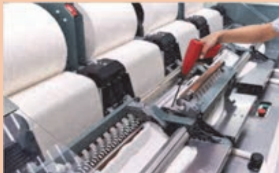
شکل ۴۲-۲ روش پرزگیری با تفنگی پرز گیر
