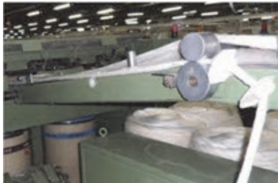
شکل ۳-۴ جفت غلتک راهنمای فتیله و قطع کننده حرکت ماشین در صورت پاره گی فتیله
