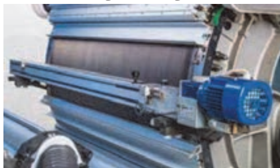
شکل ۲۳-۲ ابزار آلات مخصوص سنگ زدن وایرهای سیلندر و دافر
