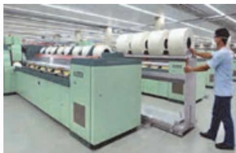
شکل ۲۵-۳ انتقال قفسه بالشچه به قسمت تغذیه شانه
