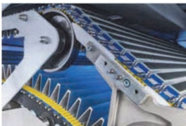
۲-۳۰ حرکت پروفیل های فلت روی تسمه های کلاهدک
