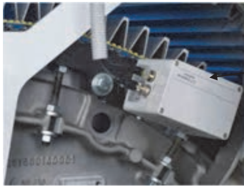
شکل ۲-۳۶ موتور تنظیم فاصله کلاهدک و سیلندر (PFS-M)
