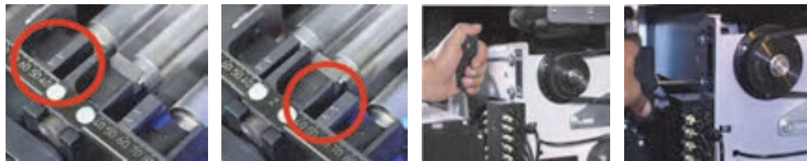
شکل ۹-۳ تنظیم نواحی کشش فاصله بین غلتک ها
