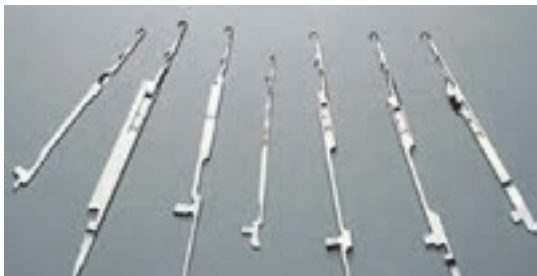
شکل ۳ دستگاه بافندگی با ساختار حلقوی پودی و انواع سوزن‌ها
