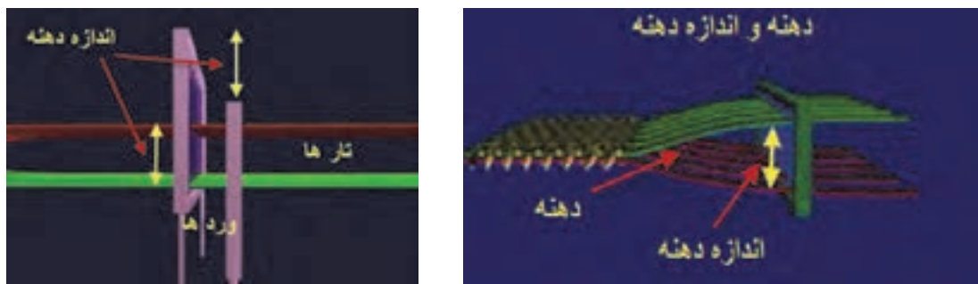
شکل ۴۴ تشکیل دهنه و اندازه آن
