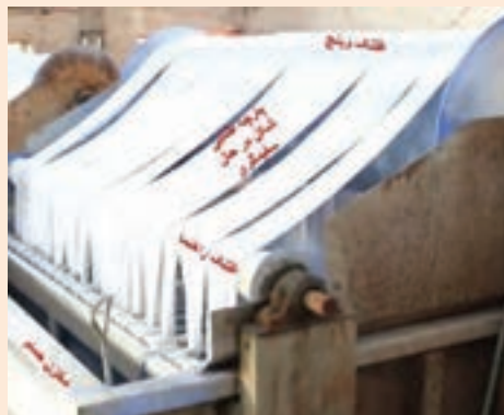
شکل ۸ تصویر یک ماشین وینچ یا هاسپل در حال عمل سفیدگری
