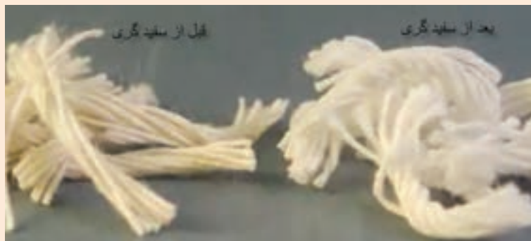
شکل ۹ تصویر نخ پنبه‌ای قبل و بعد از سفیدگری
