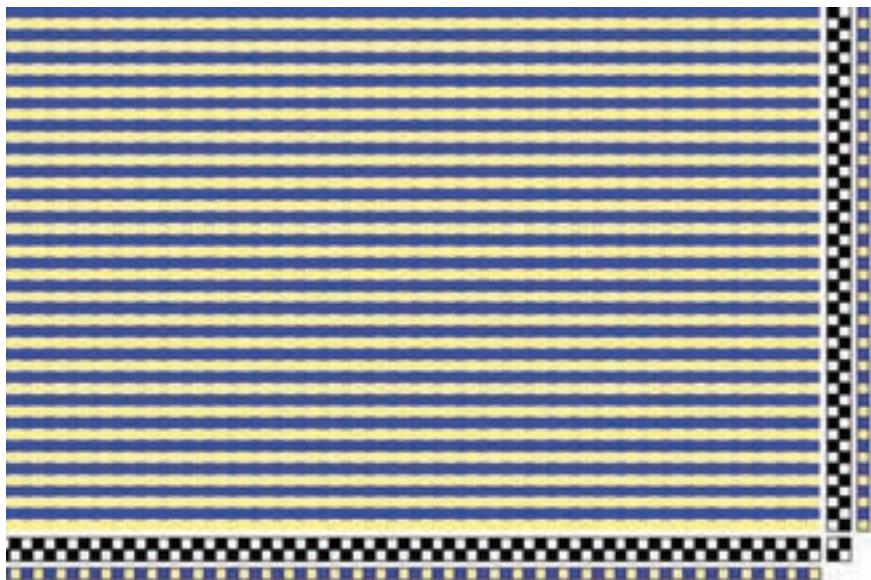
شکل ۱۰: طرح تافته با رنگ بندی یک درمیان (چهارخانه ریز)
