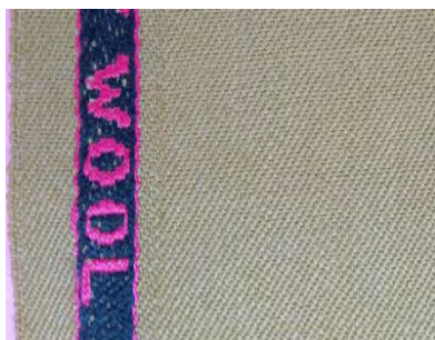
شکل ۱۱ روی پارچه و طرح روی پارچه سرژه ۲ و ۱ صعودی
