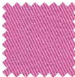
شکل ۲۱ الف پارچه گاباردین از جنس پنبه
