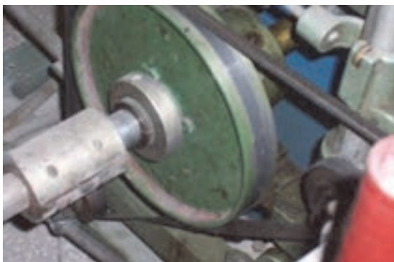
شکل ۱۸ پولی و تسمه انتقال حرکت
