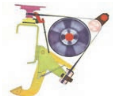
شکل ۲۹ تجهیزات ترمز گرفتن دوک
