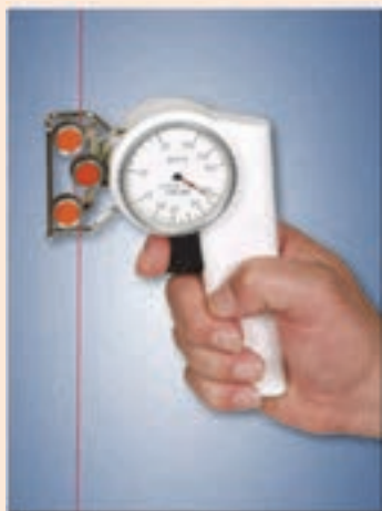
شکل ۶ دستگاه اندازه‌گیری کشیدگی نخ
