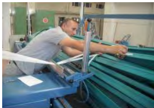
شکل ۲۲ وصل کردن نخ‌ها به میخ روی درام
