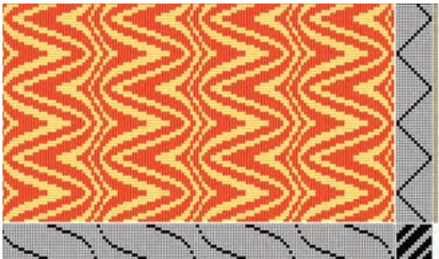
شکل ۳۷: طرح ایجاد انحنا در سرژه با تغییر در نخ‌کشی و نقشه تکرار پودی
