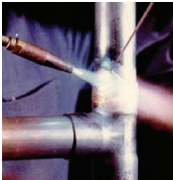
شکل ۱۴-۳- تکنیک جوشکاری به روش اکسی استیلن
