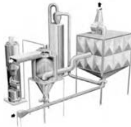
شکل ۳-۳۵- سیستم سایش نیوماتیکی برای احیای ماسه به روش خشک
