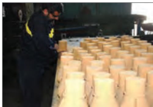
شکل ۱۸- کنترل ماهیچه‌ها هنگام انبارش
