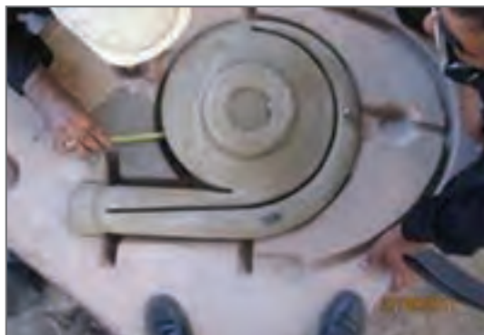
شکل ۲- قالب درجه زیرین یک قطعه صنعتی
