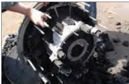
شکل ۱۰- قطعه هوزینگ ریخته شده سالم
