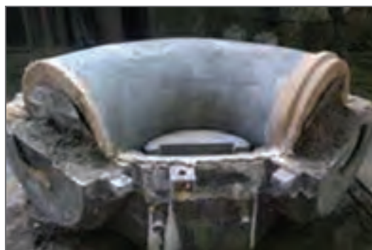
شکل ۱۷- ماهیچه زانویی پوشش داده شده
