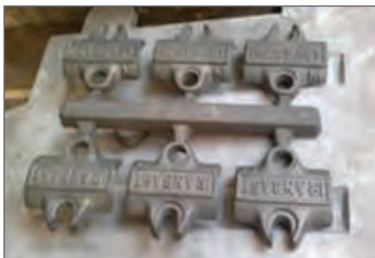
شکل ۷- قطعات ریخته گری شده با سیستم راهبار و راهبار
