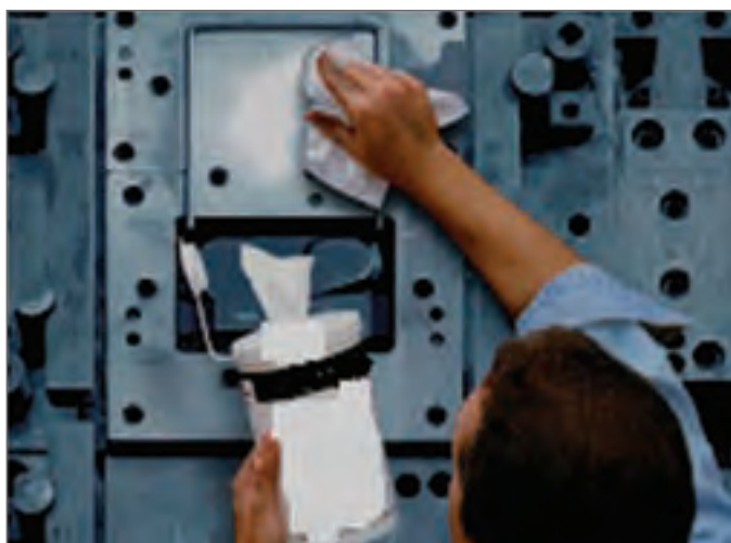
شکل (۹) تمیز کاری قالب های فلزی
