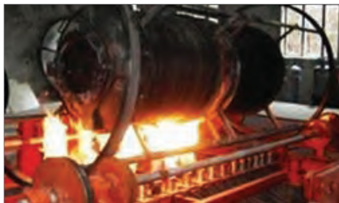
شکل ۱۲- پیش گرم کردن قالب‌های فلزی با استفاده از دستگاه‌های گرم کننده به همراه تجهیزات خنک کننده
