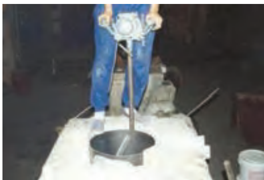
شکل ۱۸- نحوه کوبش دیواره کوره توسط کوبه ماشینی
