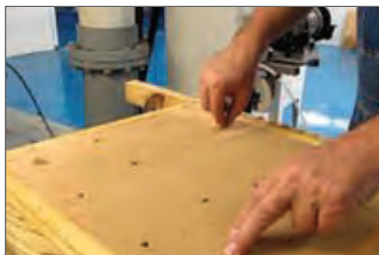
شکل ۱۳- دمش گاز CO_2 درجه رویی
