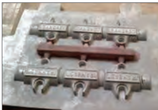
شکل ۶- راهبار و راهبار های قرار داده شده روی صفحه مدل
