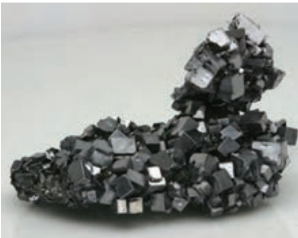
شکل ۲-۱۲- جلای فلزی در گالن
