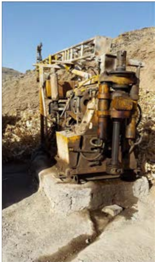
دستگاه حفاری قرار گرفته بر روی فونداسیون
