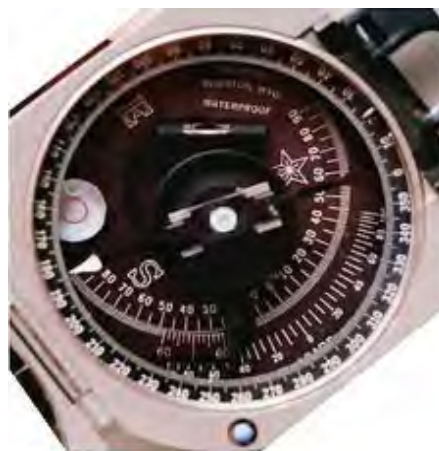
تنظیم تراز لوبیایی (استوانه‌ای) برای قرائت مقدار شیب
