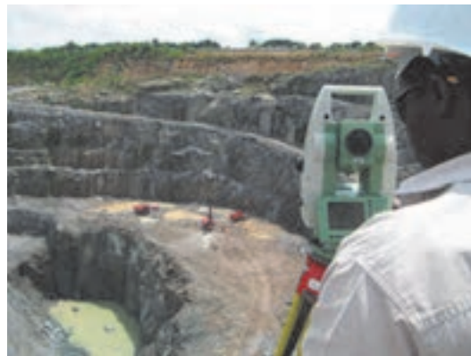
قراول روی از روی نقطه بنچ مارک در بالای پله‌های معدن به نقطه ای با دید کافی در داخل محدوده
