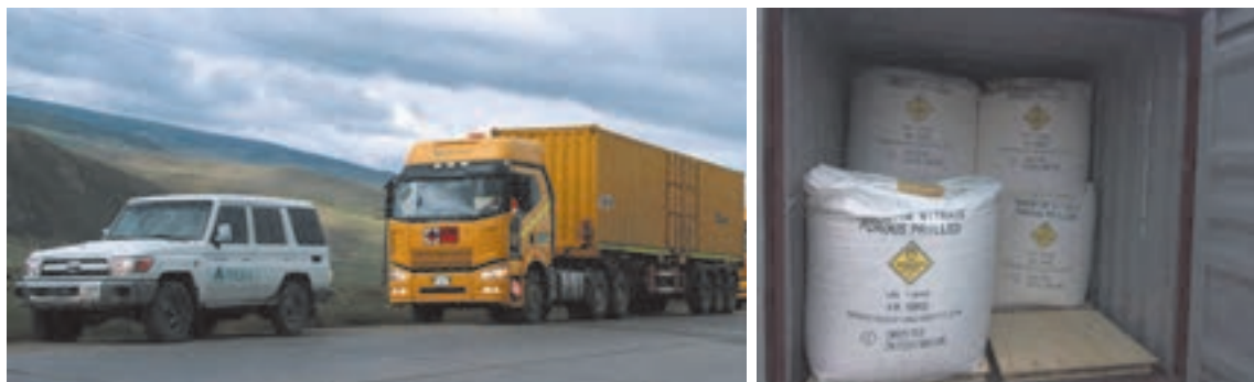
چیدن کیسه‌های آنفو در کانتینر و حمل و نقل آن توسط تریلی و اسکورت از محل تحویل تا معدن
