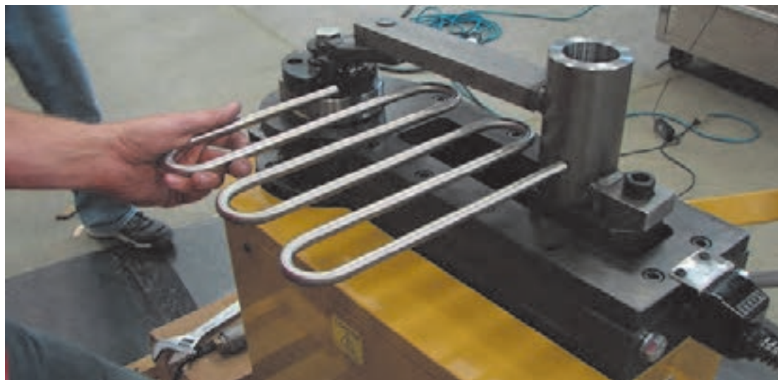
شکل ۲-۷: لوله خم شده - مبدل حرارتی -
