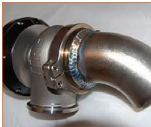
الف - جوش کاری دو قطعه فولادی
