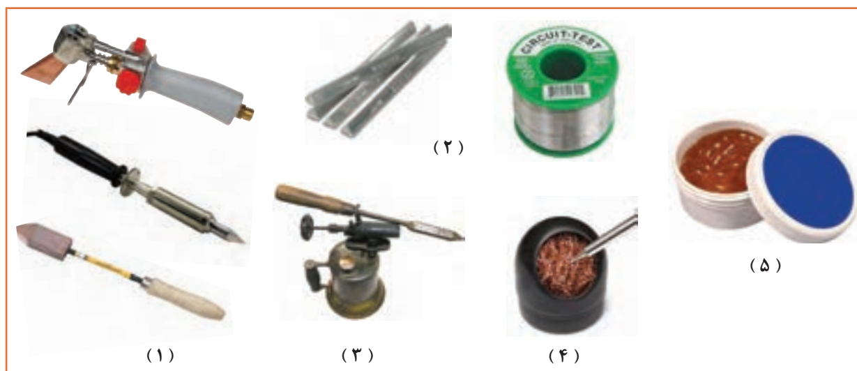
شکل ۴- تجهیزات و مواد مصرفی لحیم کاری نرم
