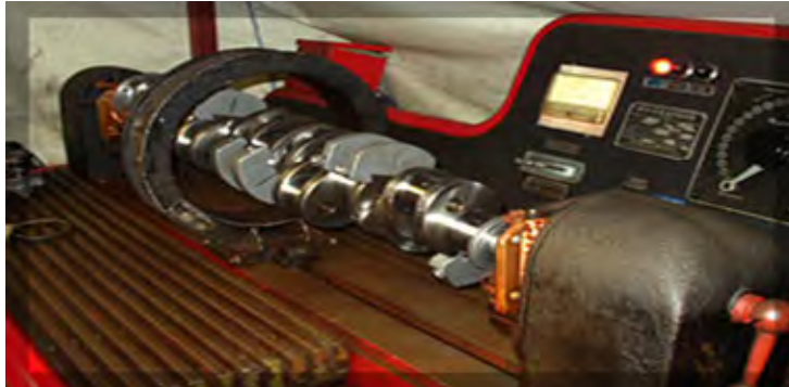
شکل ۱۱-۵- دستگاه ثابت بازرسی با ذرات مغناطیسی در حال بازرسی میل‌لنگ
