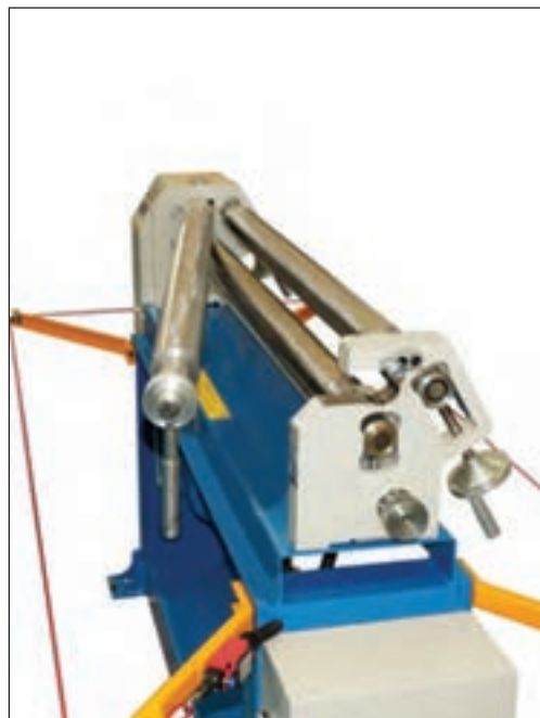
شکل ۱۵-۲ نمونه‌ای از طرق آزادسازی غلتک منحنی‌کننده در دستگاه‌های مختلف نورد
