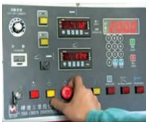
شکل ۹-۱- نمایی از صفحه تنظیمات در گیوتین CNC
