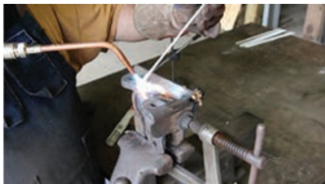
شکل (۶-۱۶) فیکسچر مورد استفاده شده در فرایند زرد جوش
