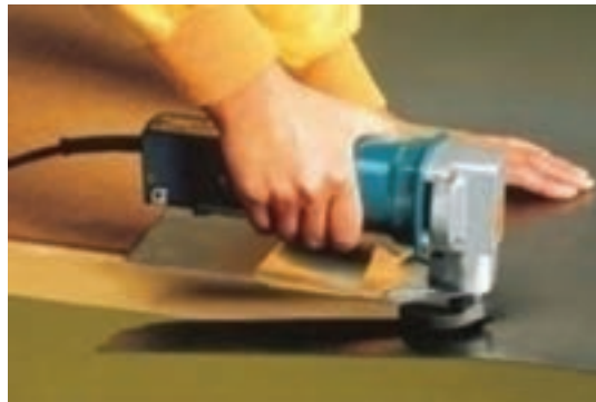
الف - نیبلر با نیرو محرکه الکتریکی
