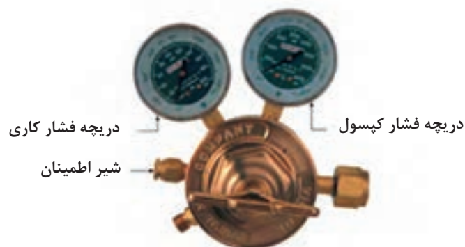
شکل ۱۵-۳- شیرهای اطمینان در رگولاتور اکسیژن
