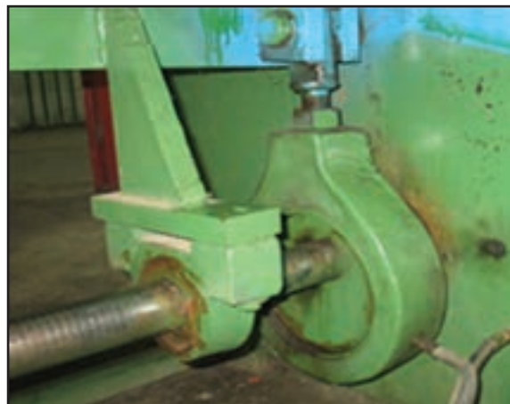
شکل ۵-۱- اجزای گیوتین مکانیکی
