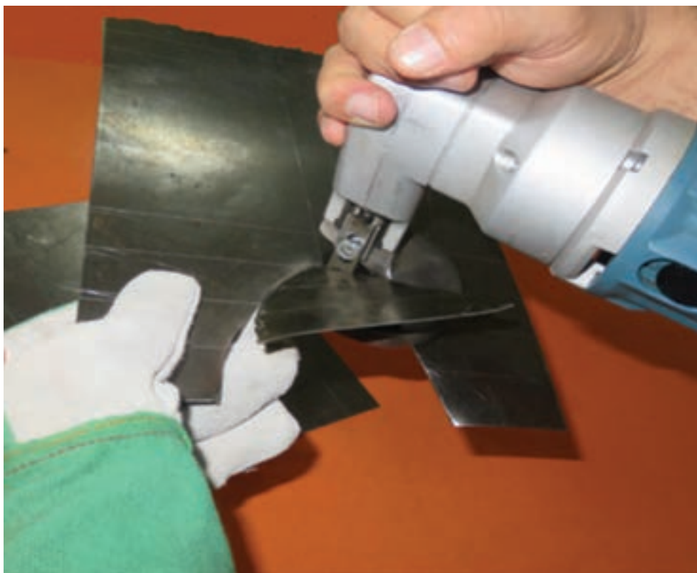
شکل ۱۲-۱- برش کاری با قیچی نیبلر
