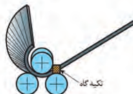
شکل ۲-۲۱ تنظیم و اجرای مخروط ناقص با دستگاه نورد
