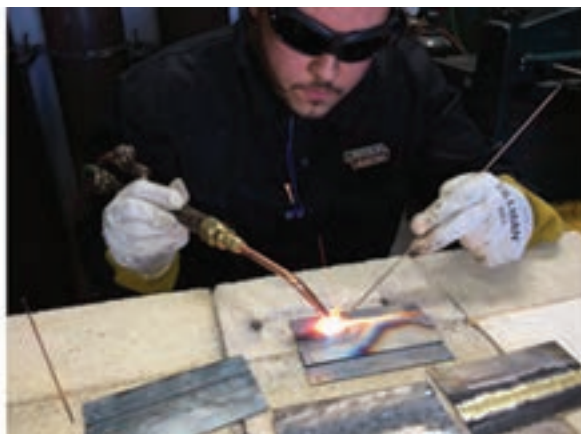
شکل (۶-۷) ذوب کردن فلز پایه و فلز پرکننده
