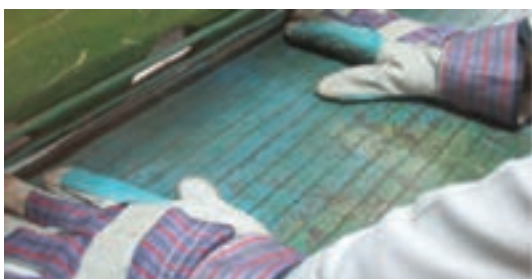
شکل ۱۷-۱ قرار گیری دستان زیر حفاظ ایمنی ممنوع
