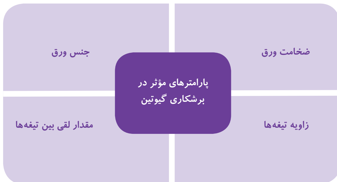
شکل ۱۰-۱- پارامترهای برشکاری با گیوتین
