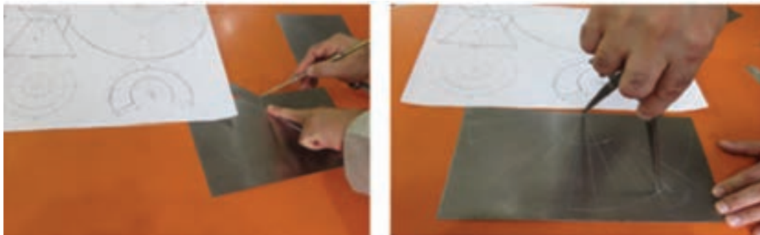
شکل ۱۴-۱ خط کش ورق فلزی با خط کش و پرگار فلزی
