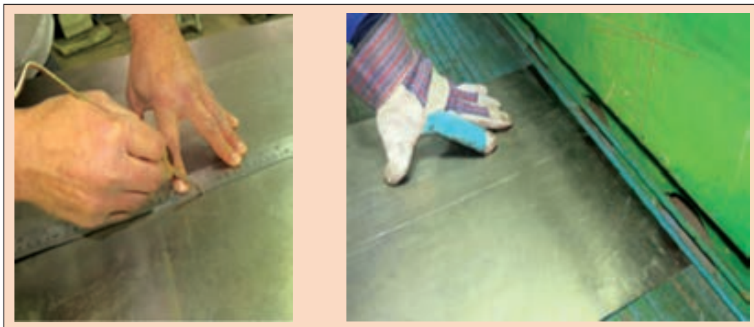
شکل ۱۴-۱ خط کشی و برش کاری ورق فولادی با گیوتین
