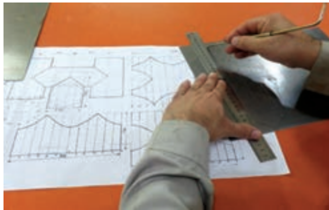
شکل ۱۰-۱- خط کشی ورق فلزی با خط کش فلزی
