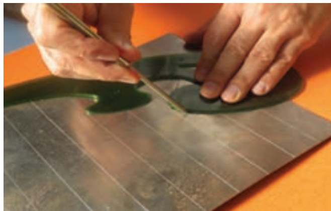
شکل ۱۱-۱- خط کشی با ورق فلزی با پیستوله
