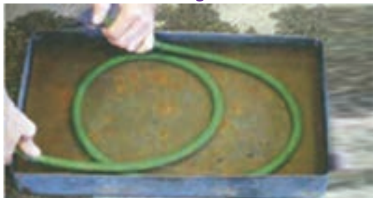
شکل ۳-۳۸- کنترل سلامت شیلنگ‌ها
