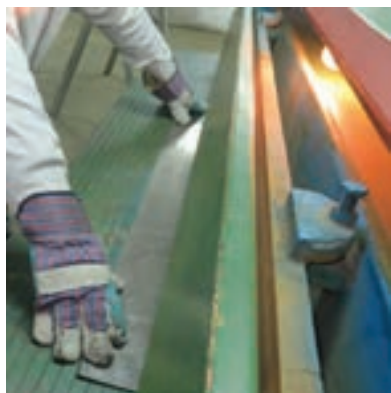
شکل ۱-۷- تنظیم خط برش با چشم توسط اپراتور
