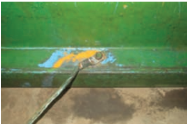
شکل ۲۳-۱- نمونه‌ای از سیم ارت در گیوتین
