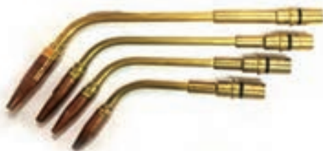
شکل ۳-۲۲. سرمشعل‌های مخصوص جوشکاری
