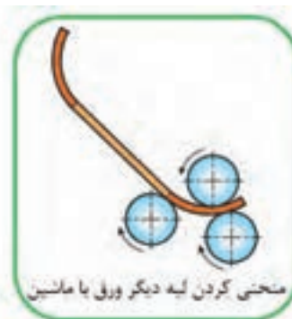
شکل ۲-۷ مراحل رول کاری با دستگاه نورد صاف کننده ساده
