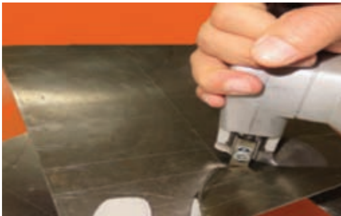
شکل ۸-۱- روش برش‌کاری با نیبلر دستی
