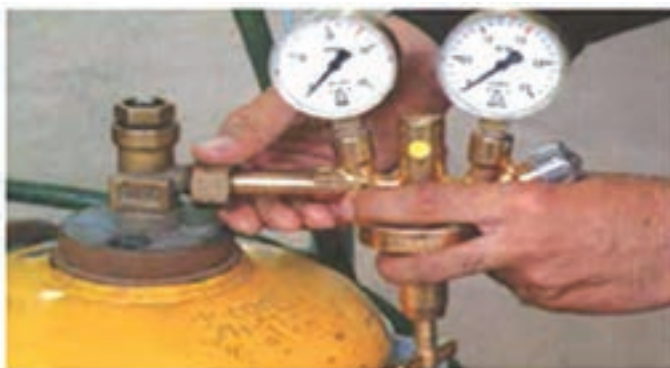
شکل ۱۸-۳- بستن رگولاتور به کپسول
