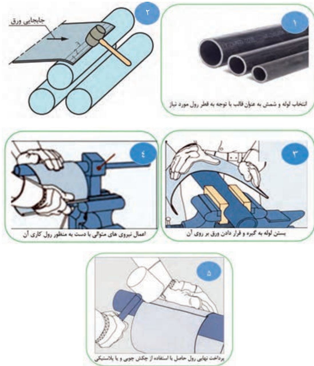
شکل ۲-۲ مراحل رول کاری با نیروی دست
