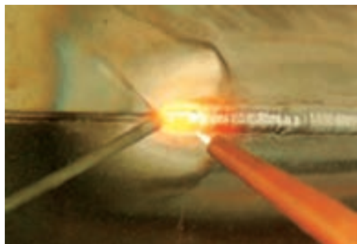
شکل ۳-۵۱- جوشکاری به روش پیش‌دستی
