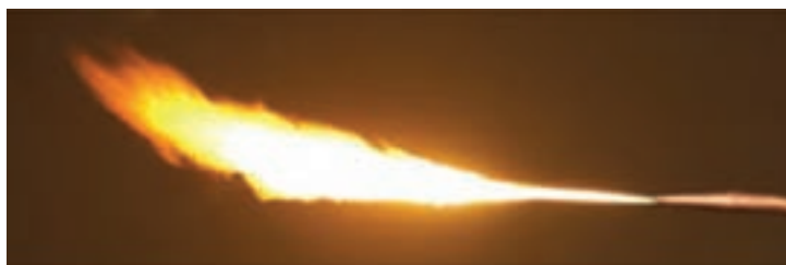
شکل ۳-۳۹ شعله احیا قوی (کربن ده)
