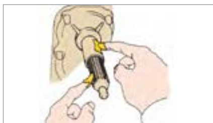
شکل ۱-۳۵- نحوه گریس کاری شفت کلاچ
