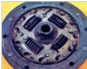
شکل ۲۷-۱- نمونه صفحه کلاچ معیوب
