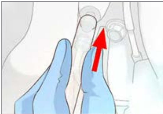
۲- شل کردن پیچ هواگیری
