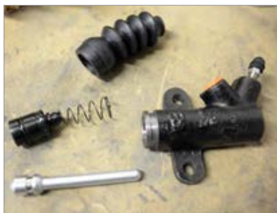
شکل ۲۴-۱- اجزای سیلندر اصلی کلاچ
