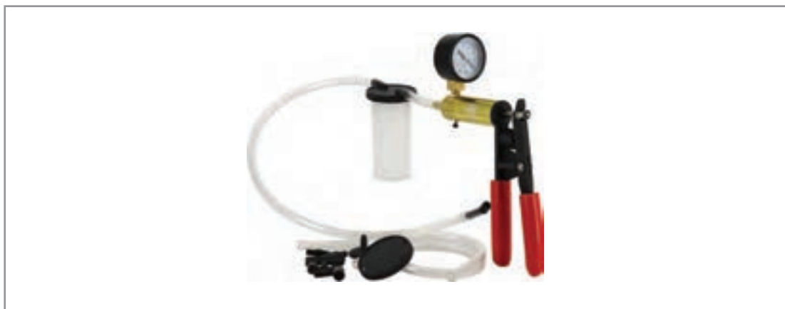
شکل ۲۳-۱- ابزار مخصوص جهت تخلیه مایع هیدرولیک
