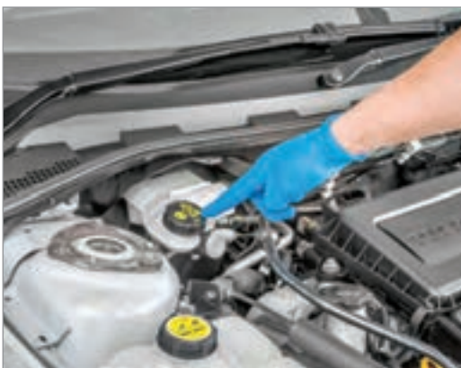
شکل ۱۶-۱- مخزن مایع مشترک در یک خودرو
