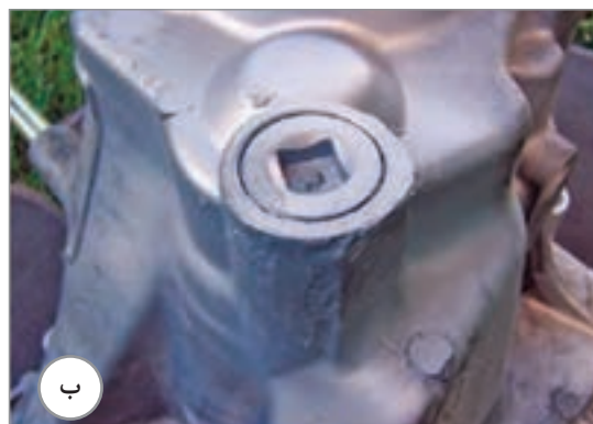
شکل ۳۲-۲- پوسته جعبه دنده و نحوه ترمیم آن
