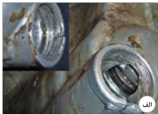
شکل ۳۲-۲- پوسته جعبه دنده و نحوه ترمیم آن
