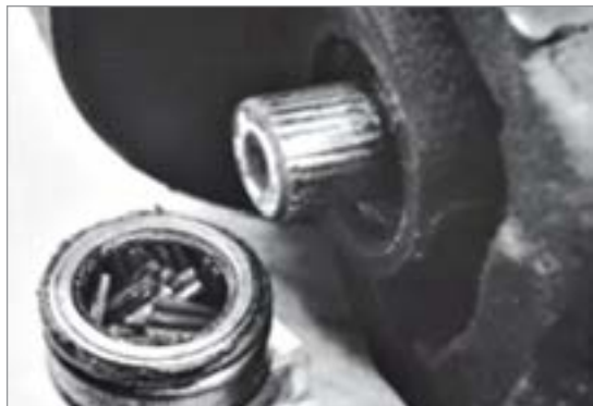
شکل ۲۳-۳- بررسی ساچمه سوزنی
