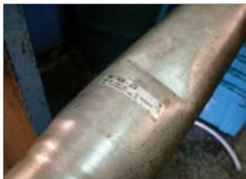
شکل ۱۵-۳ مشاهده آثار ضربه روی سطح میل گاردان
