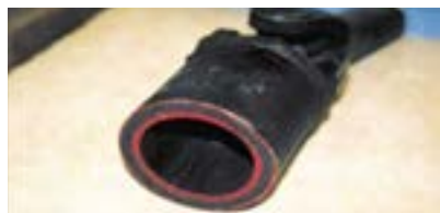
شکل ۳-۱۱- مقطع گاردان دو لایه با لایه لاستیک میانی
