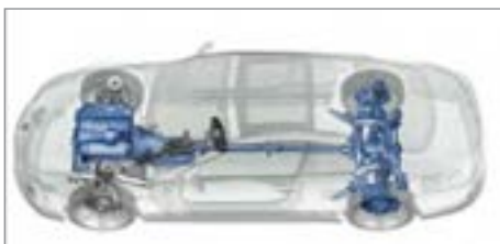
شکل ۳-۲- انتقال توان به مجموعه «گرداننده نهایی» توسط میل گاردان
