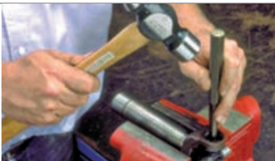
۶- بررسی اجزای باز شده گاردان
