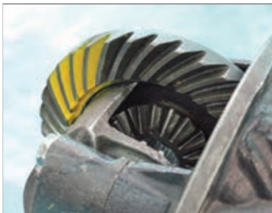
شکل ۴-۲۹- استفاده از رنگ برای کنترل
