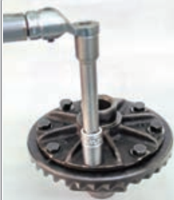
شکل ۵۸-۴- بستن پیچ‌های کرانویل
