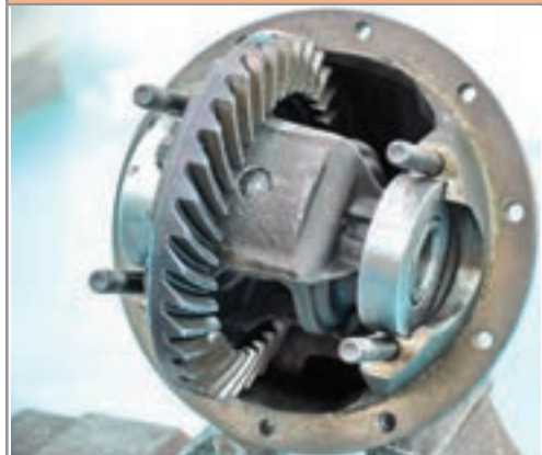
شکل ۴-۶۰- استفاده از رولبرینگ آزمایشی
