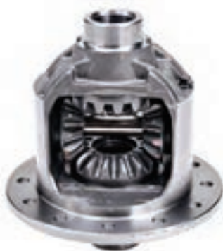
شکل ۵۷-۴- مجموعه هوزینگ
