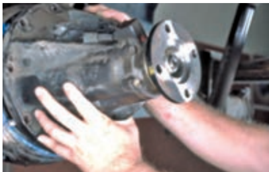
شکل ۲۵-۴ باز کردن مجموعه دیفرانسیل
