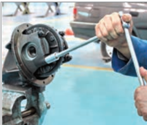
شکل ۶۱-۴ بستن کپه یاتاقان‌ها
