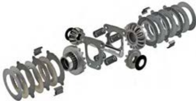
شکل ۵-۴ اجزای دیفرانسیل ضد لغزش
