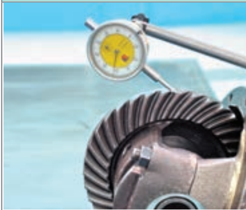
شکل ۶۲-۴ اندازه‌گیری لقی بین دنده‌ها
