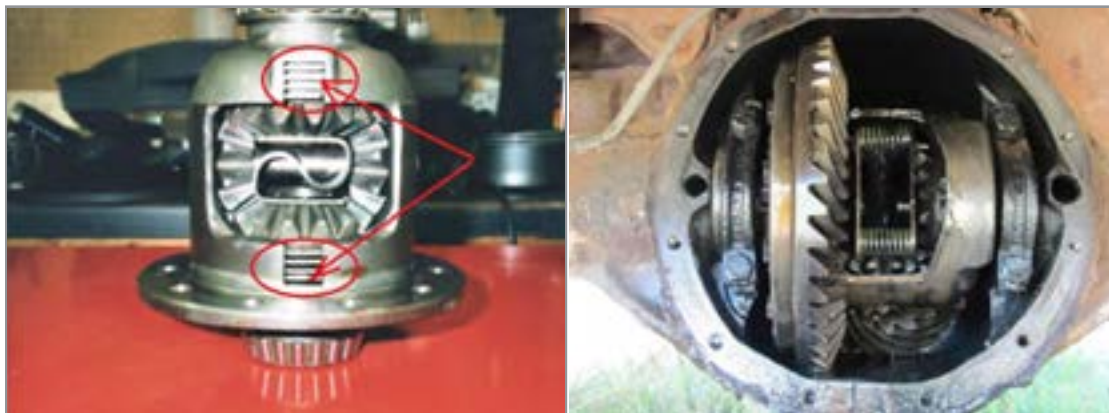
شکل ۷-۴- هوزینگ دیفرانسیل ضد لغزش و فنرها
