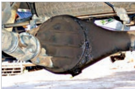
شکل ۱۵-۴- نقاط احتمالی نشتی در دیفرانسیل محرک عقب
