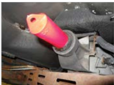
شکل ۳-۱۹- استفاده از ابزار مخصوص کورکن
