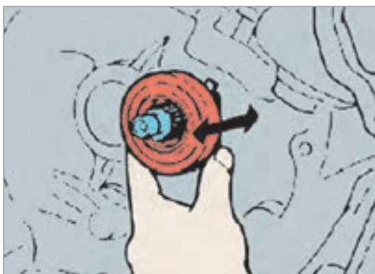
شکل ۱-۴۰- نحوه بررسی حرکت بلبرینگ کلاچ روی شفت کلاچ
