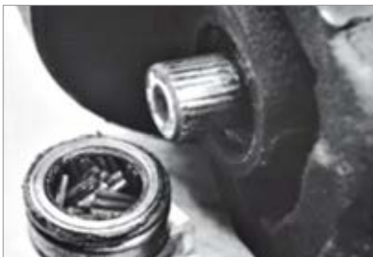
شکل ۲۳-۳- بررسی ساچمه سوزنی
