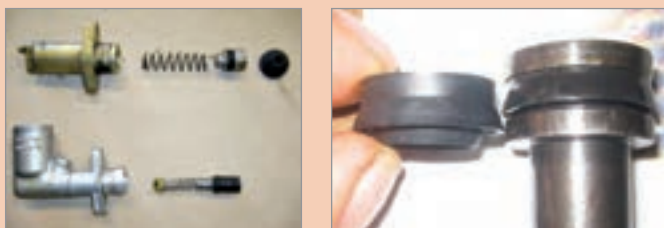
شکل ۲۱-۱- الف) نشتی داخلی در مدار هیدرولیکی
