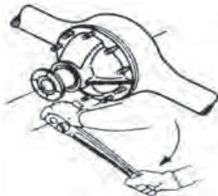
شکل ۶۴-۴- اعمال گشتاور مناسب هنگام بستن
