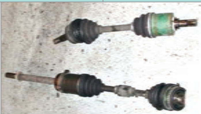
شکل ۲-۳۴- بررسی پلوس و دسته موتور
