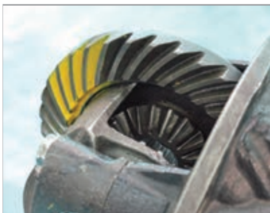
شکل ۴-۲۹- استفاده از رنگ برای کنترل
