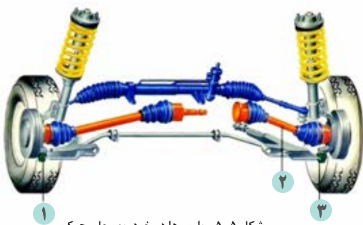
شکل ۵-۵- پلوس ها در خودروی جلو محرک
