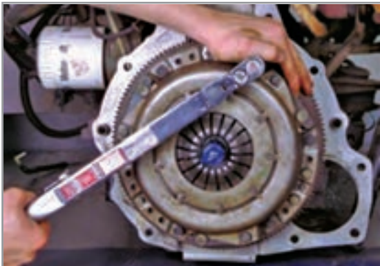
شکل ۱-۳۹- نحوه به گشتاور رساندن پیچ های دیسک کلاچ
