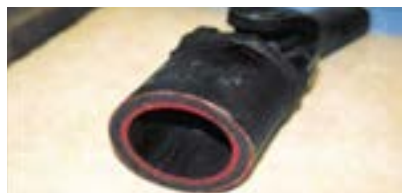
شکل ۳-۱۱- مقطع گاردان دو لایه با لایه لاستیک میانی
