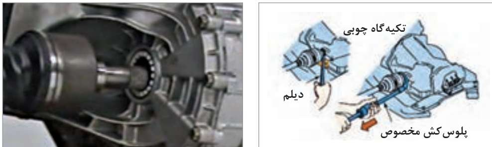
شکل ۱۹-۵ - خارج کردن پلوس با ابزار مخصوص
