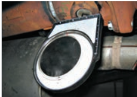
شکل ۱۳-۳ روش استفاده از زاویه سنج میل گاردان
