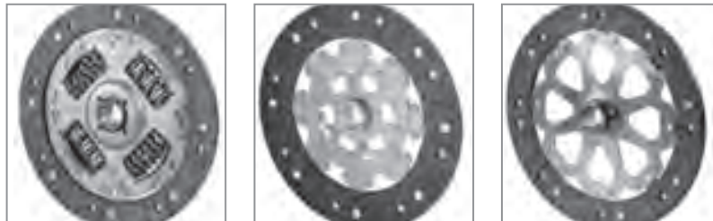
صفحه کلاچ با فنرهای مارپیچ صفحه کلاچ با بدنه چند پارچه (انعطاف پذیر) صفحه کلاچ با بدنه یکپارچه
