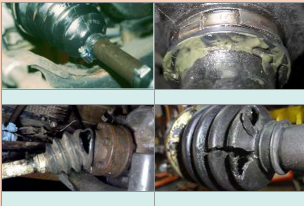
شکل ۱۷-۵- روش بررسی ظاهری پلوس‌ها
