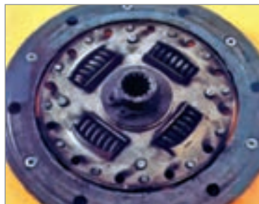
شکل ۲۷-۱- نمونه صفحه کلاچ معیوب
