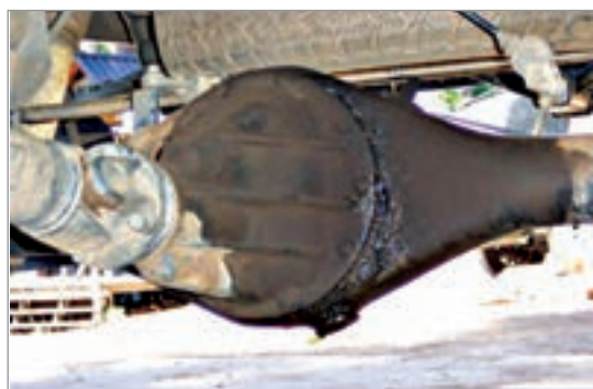
شکل ۱۵-۴- نقاط احتمالی نشتی در دیفرانسیل محرک عقب
