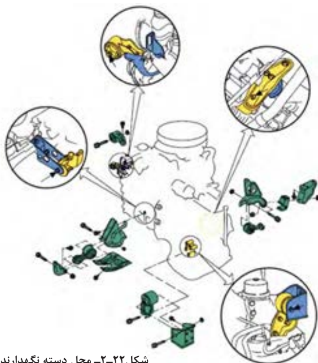
شکل ۲-۲۲- محل دسته نگهدارنده جعبه دنده
