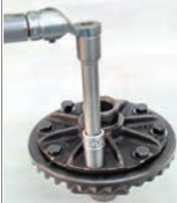
شکل ۵۸-۴- بستن پیچ‌های کرانویل
