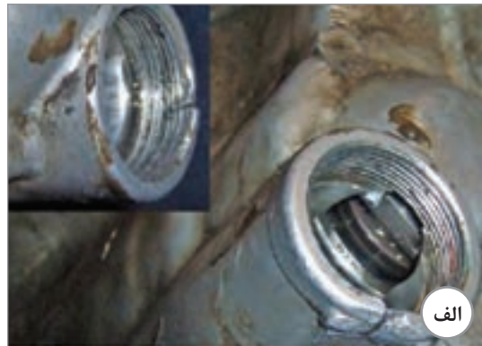
شکل ۳۲-۲- پوسته جعبه دنده و نحوه ترمیم آن
